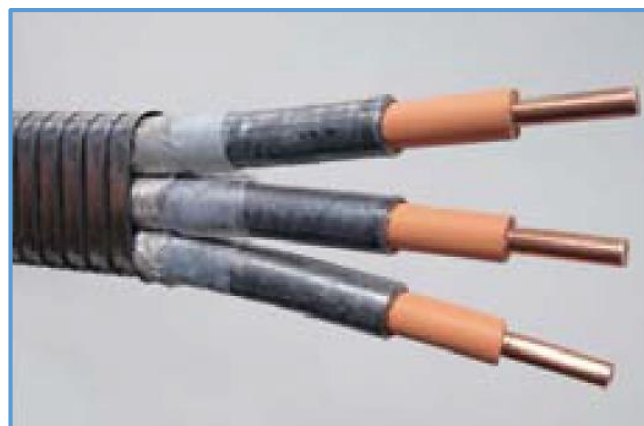
Figura 2.12. Cable de energía para alta temperatura, aislante EPDM (etileno propileno dieno) con barrera de plomo, cinta de teflón y cinta aislante.
