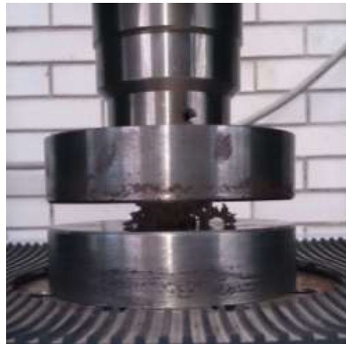
Figura 4.5 a) Gráfica esfuerzo-deformación de la probeta que falló con la precarga de 1000[N], b) y c) muestran la evolución de su deformación, se observa disminución de altura y cómo la medula ósea es expulsada del interior de la misma.
