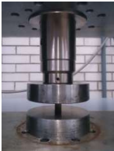
Figura 3.6 Colocación típica de las probetas entre los cabezales para prueba de relajación de esfuerzos
