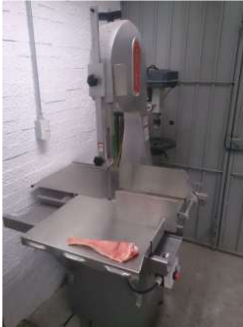
Figura 3.2 Cortadora de sierra con la cual se seccionó la pieza completa de hueso femoral bobino.
