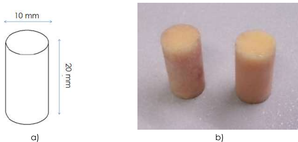
Figura 3.1 a) Geometría de las probetas de hueso trabecular de trabajo, b) ejemplo de probetas reales con que se realizaron las pruebas.
