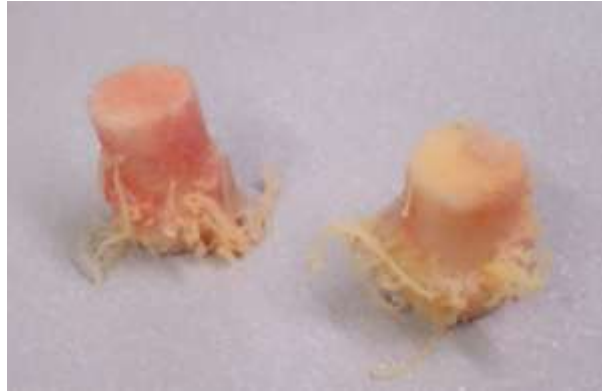
Figura 4.12 Aspecto final de las Probetas 1 y 5 tras ser sometidas a 700 ciclos de carga.
