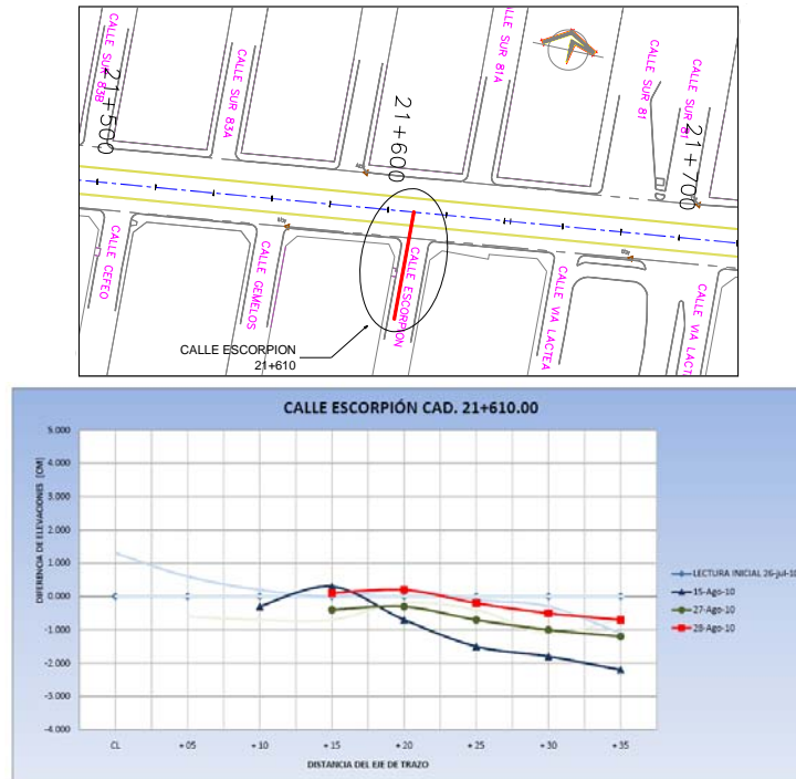
Figura 4.27 Desplazamientos verticales de la superficie del terreno medidos en la dirección transversal al eje del túnel en el cadenamiento 21+610 km
