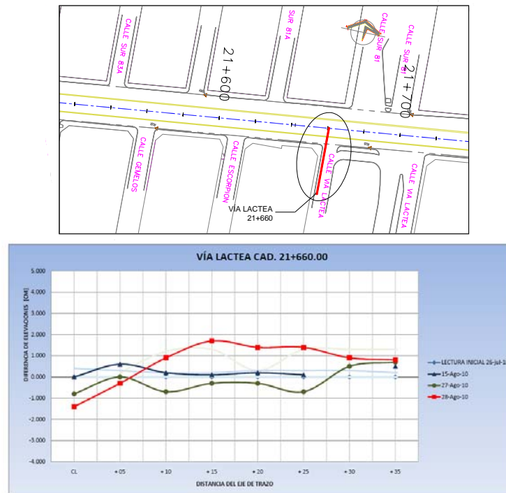
Figura 4.29 Desplazamientos verticales de la superficie del terreno medidos en la dirección transversal al eje del túnel en el cadenamiento 21+660 km
