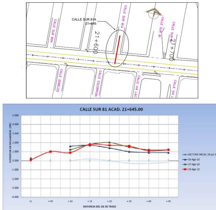
Figura 4.28 Desplazamientos verticales de la superficie del terreno medidos en la dirección transversal al eje del túnel en el cadenamiento 21+645 km
