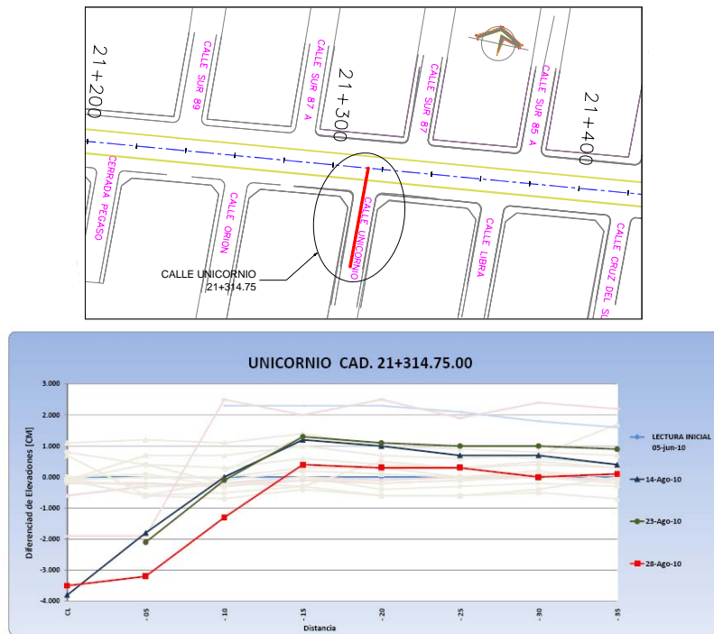
Figura 4.10 Desplazamientos verticales de la superficie del terreno medidos en la dirección transversal al eje del túnel en el cadenamamiento 21+315 km
