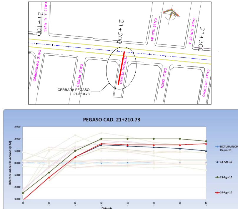
Figura 4.7 Desplazamientos verticales de la superficie del terreno medidos en la dirección transversal al eje del túnel en el cadenamiento 21+211 km
