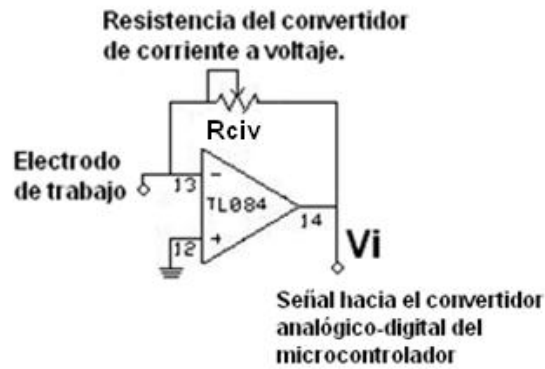
Figura 2.17. Convertidor de corriente a voltaje.
