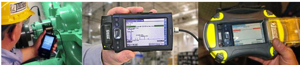
Fig. 38 Analizador de espectro acoplado a una maquina.
