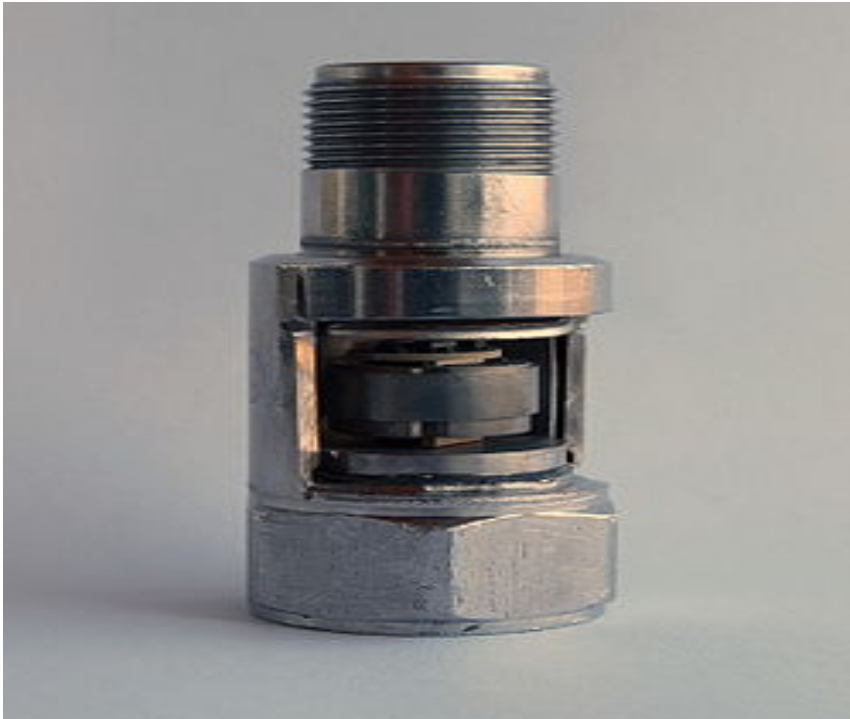
Fig. 36 Acelerómetro piezoeléctrico de cuarzo.
