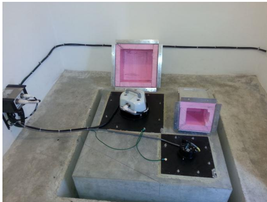
Fig. 3.13 Sensores de velocidad (izquierda) y aceleración (derecha). Imagen proporcionada por F. Navarro.
