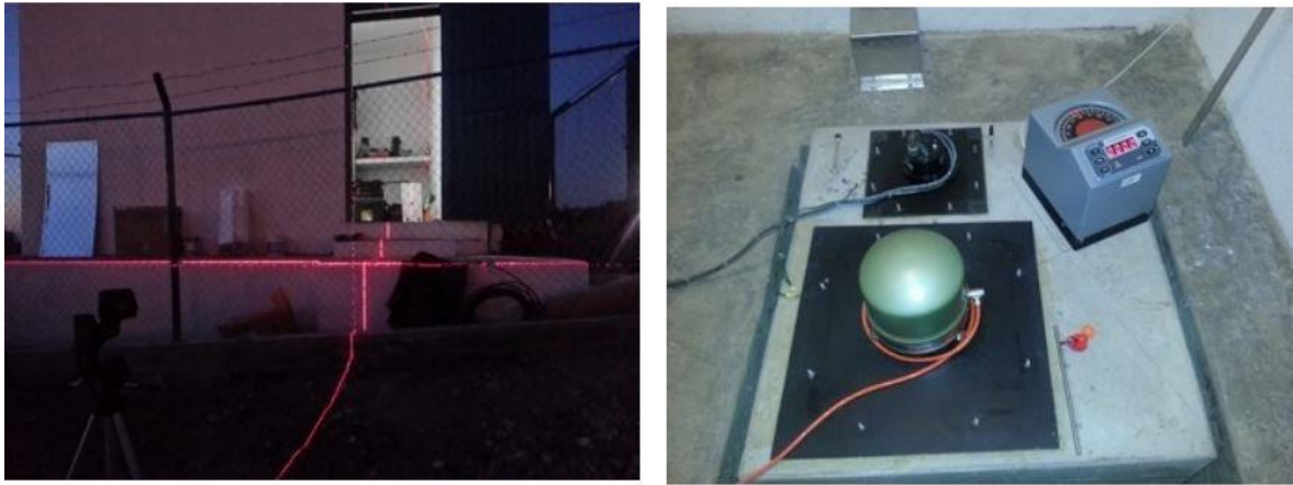
Fig. 3.12 Norte geográfico. Izquierda: Orientación del sensor con brújula. Derecha: orientación del sensor con giroscopio. Imagen proporcionada por F. Navarro.
