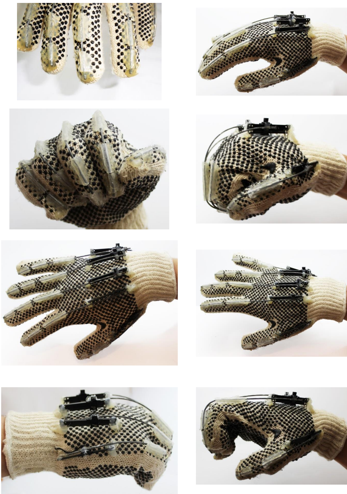
Figura 6.7 Primer prototipo del guante con sistema sensorial.
