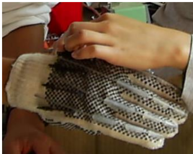
Figura 6.6 Colocación de potenciómetros sobre los huesos metacarpianos de los dedos en el guante.
