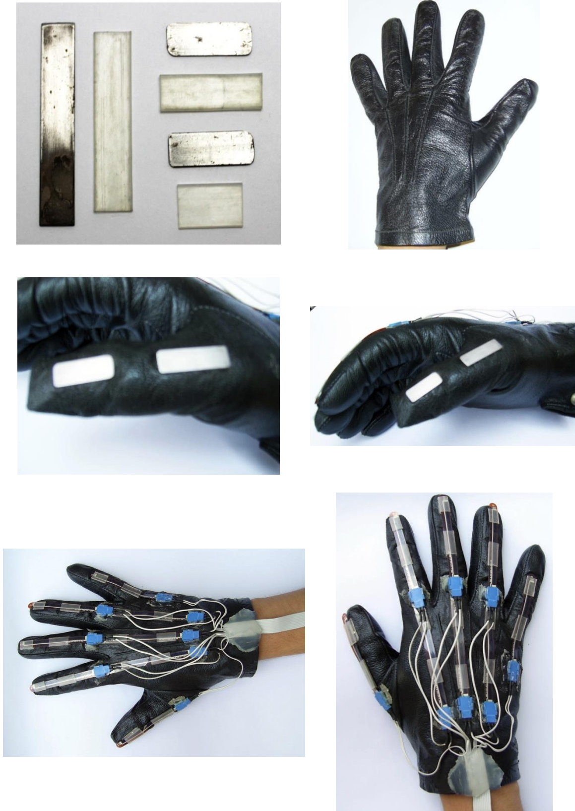
Figura 6.10 (b) Construcción del segundo prototipo del guante con sistema sensorial.
