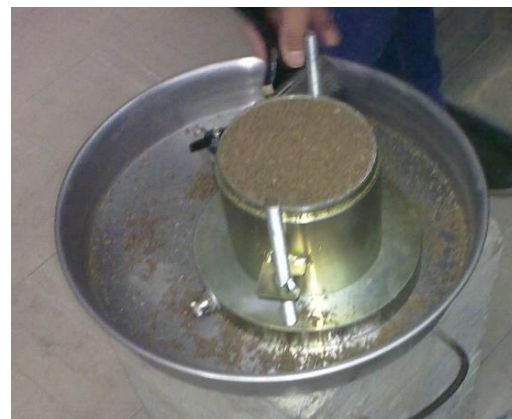
Figura A.13. Limpieza exterior del molde
