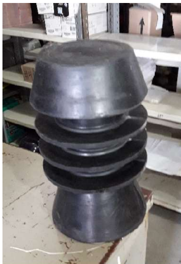
Figura II.65. Tapón Suelto “Diablo”, [Cortesía ICA].
