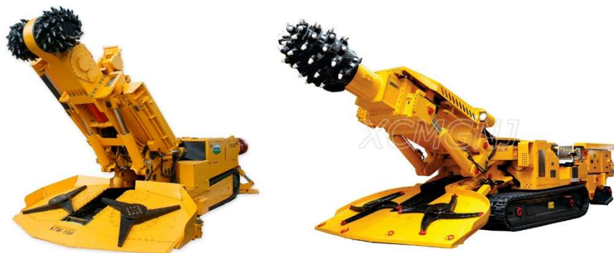
Figura 1.92. Equipos de excavación mecanizada de ataque puntual (Rozadoras). Ref. [121], y [122].
