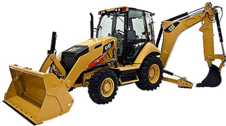
Figura II.57. Retroexcavadora marca Caterpillar, modelo 416F, [Cortesía ICA]
