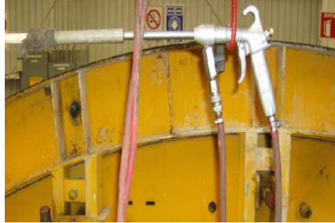
Figura III.97 Rociador de desmoldante. [Cortesía ICA].
