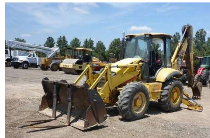
Figura II.58. Retroexcavadora marca Komatsu, modelo 13X, [Cortesía ICA]
