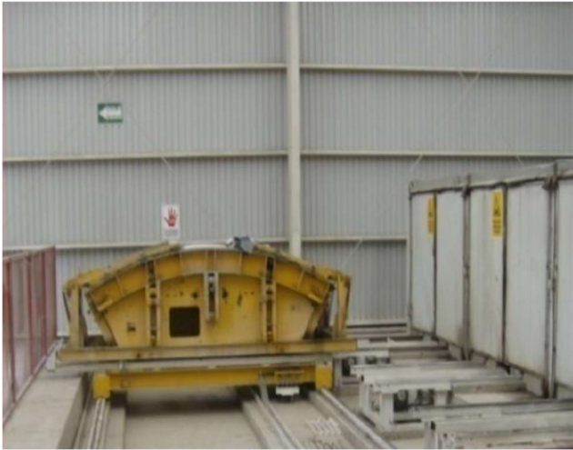
Figura II.39. Entrada de moldes a la cámara de curado de dovelas. [Cortesía ICA]
