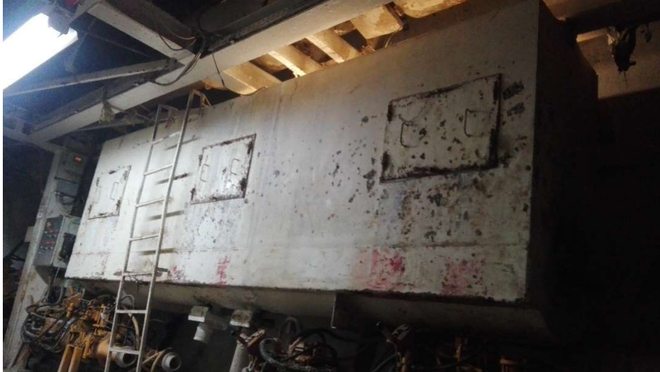
Figura II.10. Tanque de mortero de inyección del espacio anular del escudo EPB (HK-S364), [Propia]
