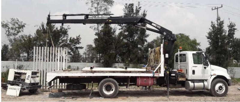
Figura II.61. Grúa HIAB, modelo 6 ton, [Propia]
