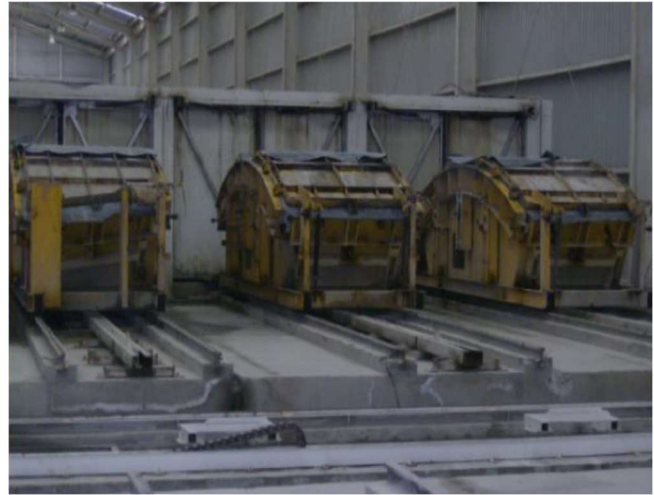
Figura II.40. Reingreso de etapas y salida de moldes a la cámara de curado de dovelas. [Cortesía ICA]
