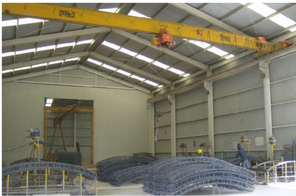
Figura II.32. Grúa viajera HAWI tipo monopunte. [Cortesía ICA]
