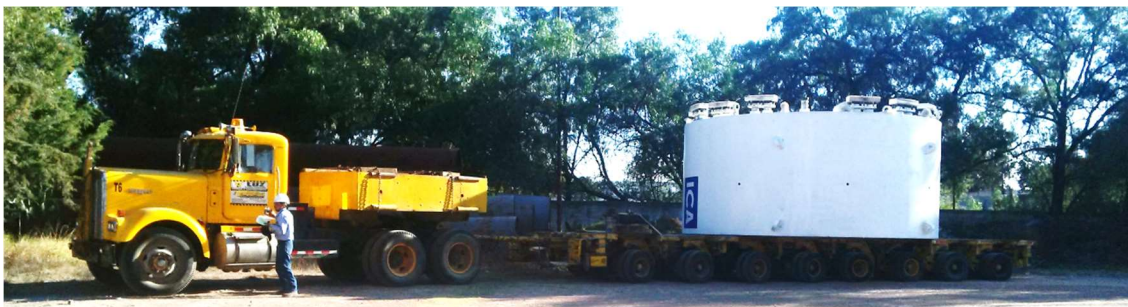
Figura III.124 Lowboy con segunda parte de la tuneladora EPB. [Cortesía Ing. Eduardo Zaragoza].
