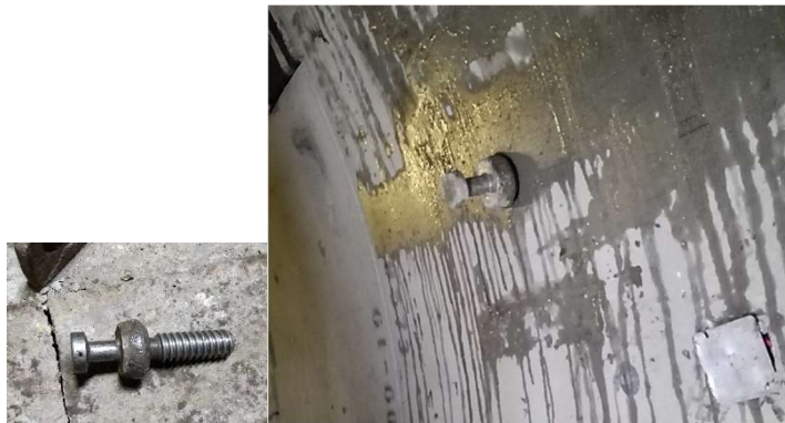
Figura II.25. Perno roscado del escudo EPB (HK-S364), [Propia]
