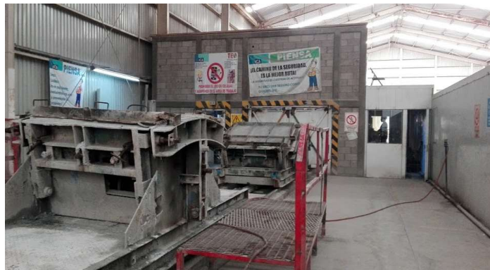
Figura III.106 Cámara de colocación y vibrado de concreto [Propia].
