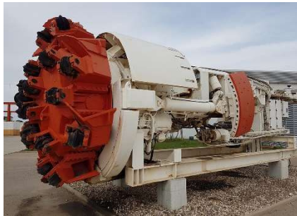
Figura 1.71. Equipos de excavación mecanizada a sección completa (Topo, escudo y empuje de tubos).
