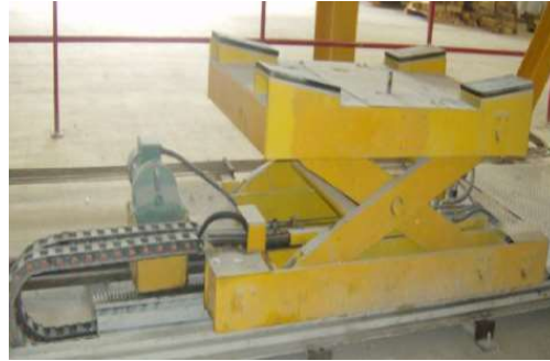
Figura III.116 Mesa elevadora para dovelas [Cortesía ICA].
