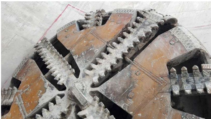
Figura 1.81. Fotografía de rueda de corte en Lumbrera L2-TCX. [Propia].
