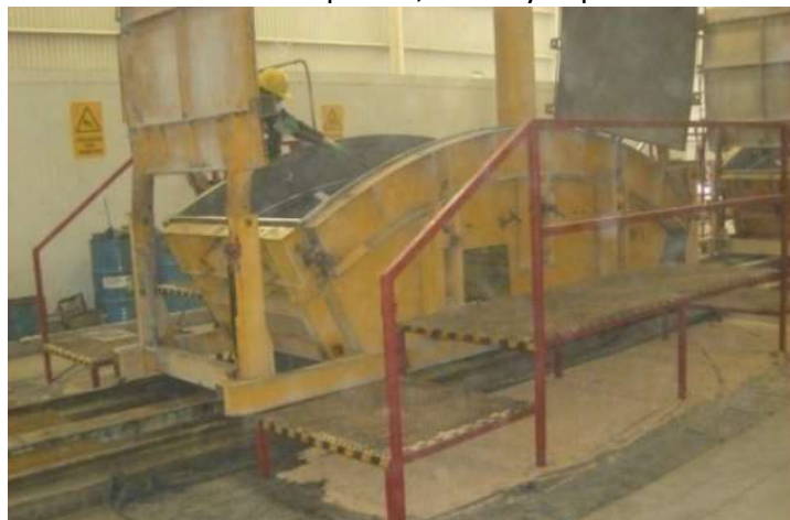
Figura III.95 Limpieza de molde para dovela. [Cortesía ICA].
