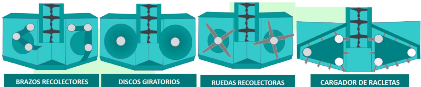
Figura 1.99. Dispositivos típicos de recolección de rezaga de rozadoras. Ref. [126]
