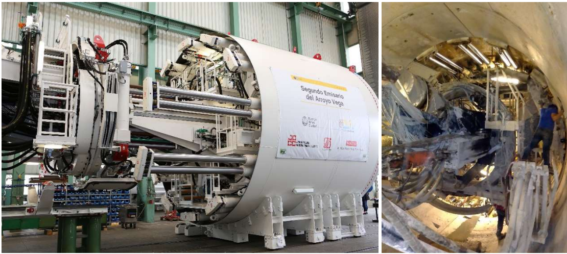
Figura 1.82. Cilindros de empuje en tuneladora. Ref. [109] y [Propia].
