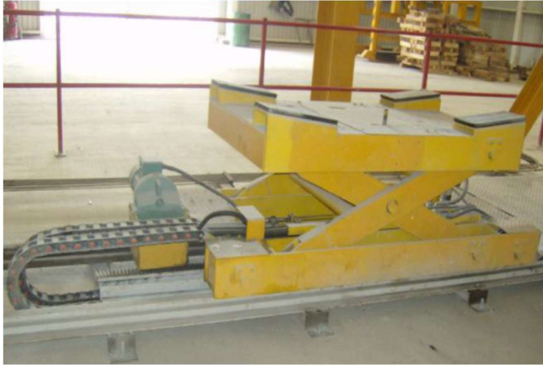
Figura II.44. Carro con elevador para desalojo de dovelas. [Cortesía ICA]
