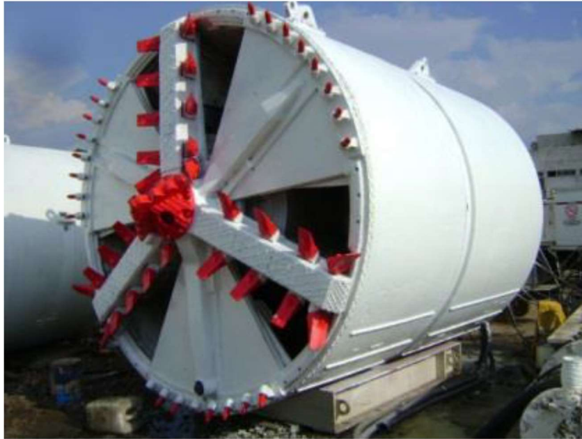
Figura 1.87. Escudos abiertos y sus tipos de brazos. [Cortesía Ing. Isaías Hernández Soto].
