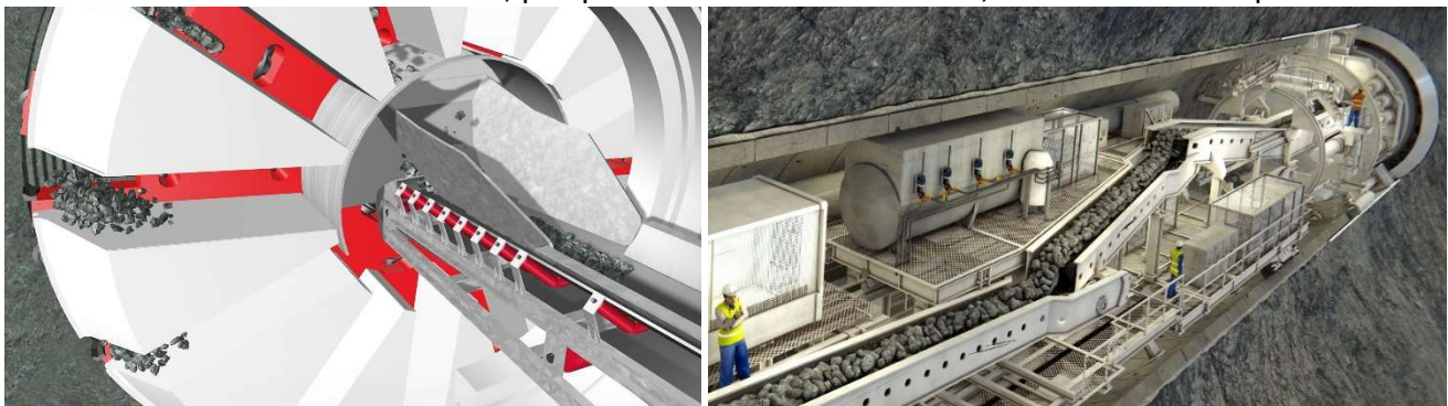
Figura 1.79. Sistema de rezaga. Ref. [107] y [108].
