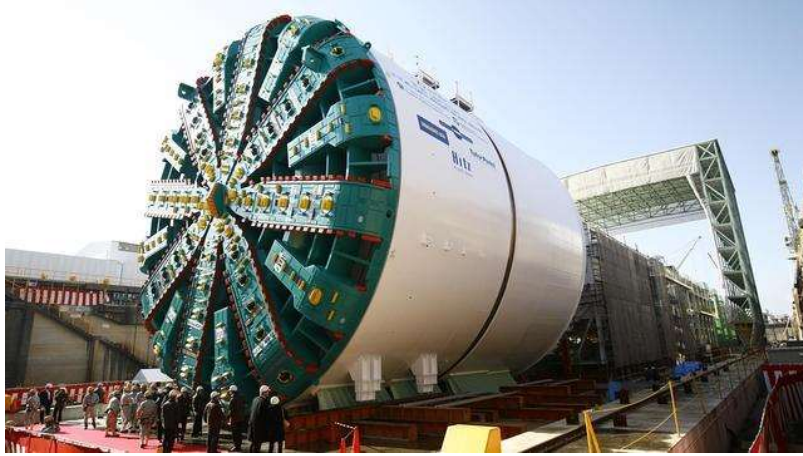
Figura 1.29. Máquina excavadora “Big Bertha”. Ref. [61].
