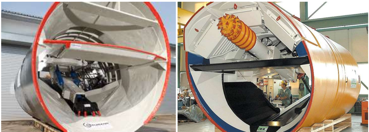
Figura 1.88. Escudos abiertos y sus tipos de brazos. Ref. [115] y [116].
