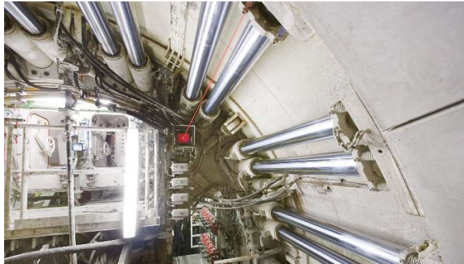
Figura 1.85. Sistema de guiado de escudo. Ref. [112]
