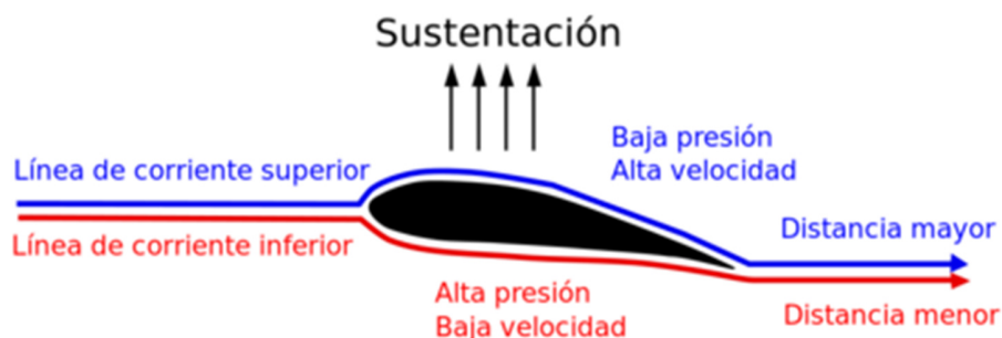
Figura 4.4. Flujo de aire sobre ala. Fuente: Xataka.com [14]
