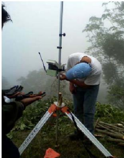
Foto 29 y Foto 30. Colocación de la estación total en los bancos de materiales.
