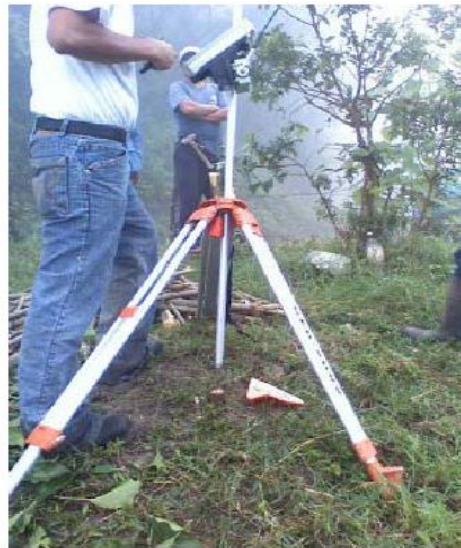
Foto 29 y Foto 30. Colocación de la estación total en los bancos de materiales.
