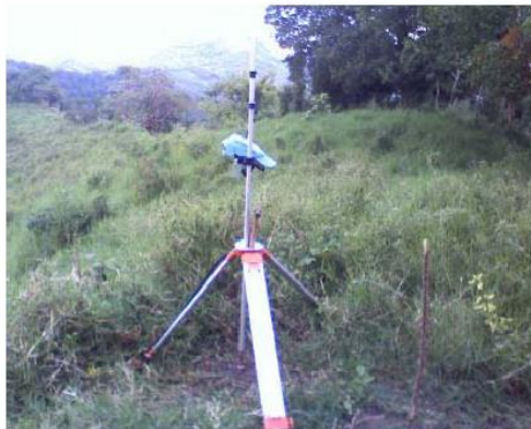
Foto 28. Vista del equipo de la estación total utilizada en el levantamiento topográfico de los bancos de materiales.
