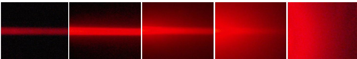
Figura 2. Ilustraciones de las componentes coherente y difusa de luz. Cuando la concentración de partículas es muy baja la componente coherente domina sobre la difusa (imagen más a la izquierda), conforme la concentración se incrementa la componente difusa domina hasta que eventualmente la componente coherente desaparece (imagen más a la derecha)
