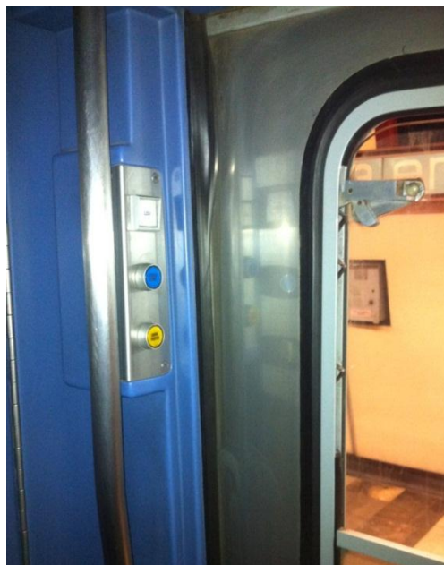
Fig. 53: Botones de apertura y cierre de puertas.
