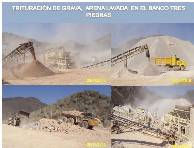
FIG. 5.26 TRITURACION DE GRAVA, ARENA LAVADA EN BANCO TRES PIEDRAS
