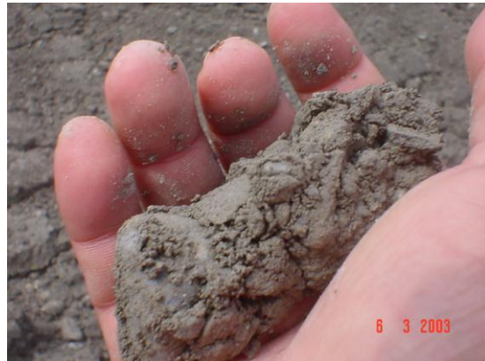
Fig. 2.3 INSPECCION AL TACTO DE CONTENIDO DE HUMEDAD DE CCR
