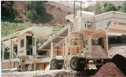
FIG. 4.17 PLANTA DE CCR TEREX , PRODUCCIÓN DE 150 A 600 TON/H, MEZCLADOR DOBLE ( PUG MILL )
