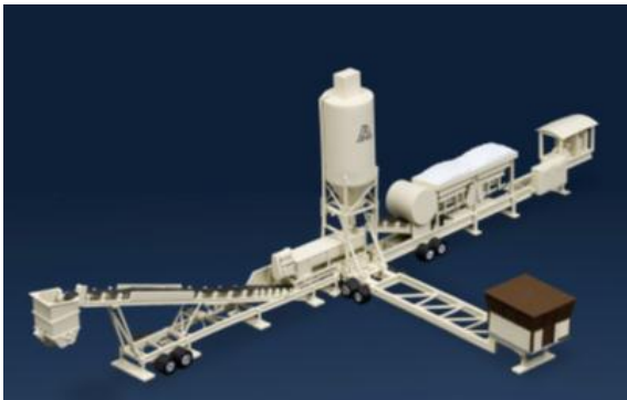
FIG. 4.18 LAS PLANTAS DE CONCRETO COMPACTADO ASTEC INCORPORAN FUNCIONES AVANZADAS QUE INCLUYEN PUNTES DE PESAJE, UN MEZCLADOR CON DOS EJES Y UN SILO AUTOEREGIBLE QUE LE AYUDAN A GESTIONAR UNA PRODUCCIÓN RENTABLE
