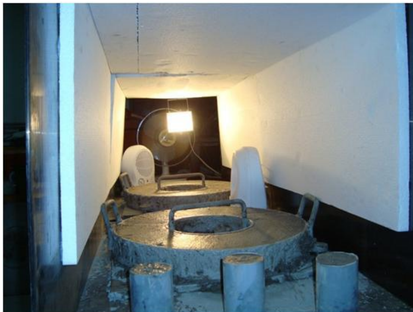
Figura 1.4 Equipo de la prueba de contracción plástica
