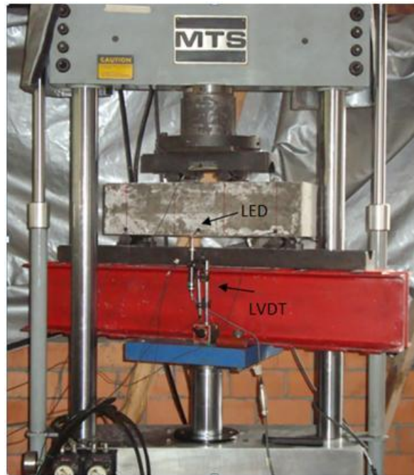
Figura 1.7 Dispositivo para la prueba de flexión y tenacidad
