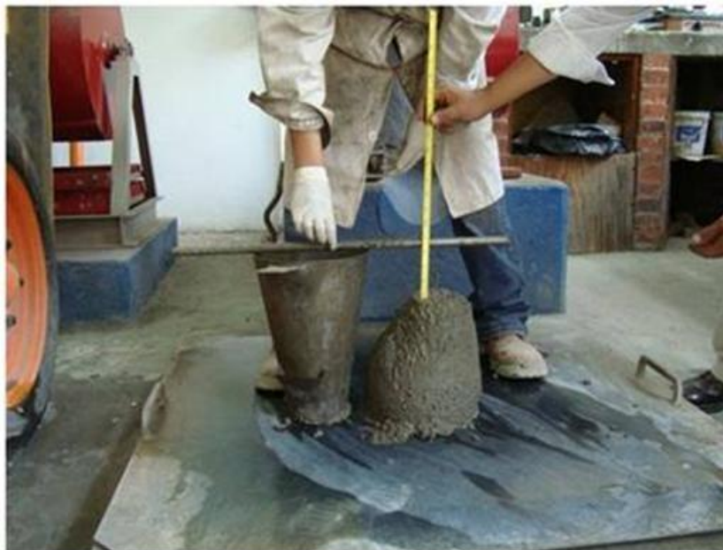
Figura 1.1 Prueba de revenimiento realizada en el laboratorio
