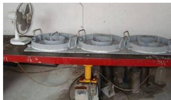
Figura 1 Molde para la prueba de contracción plástica
