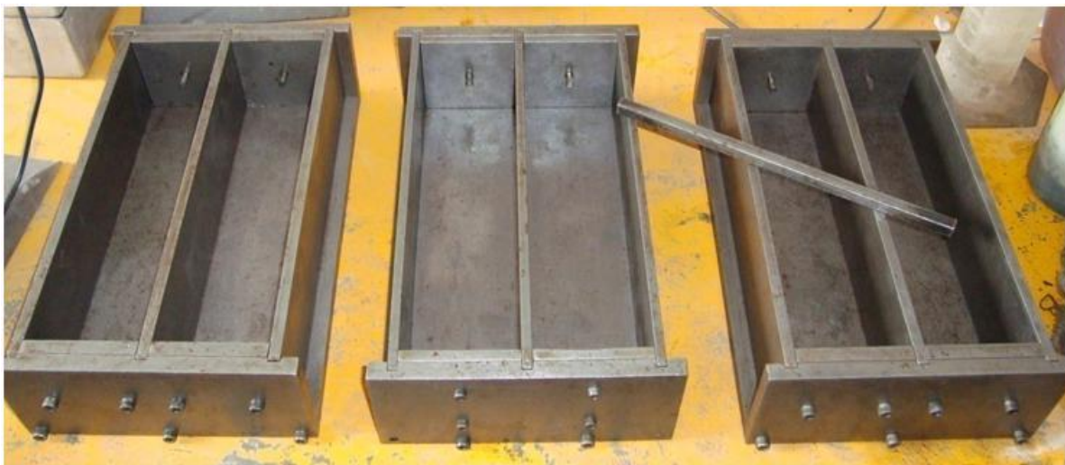
Figura 1.11 Moldes para las barras de contracción por secado
