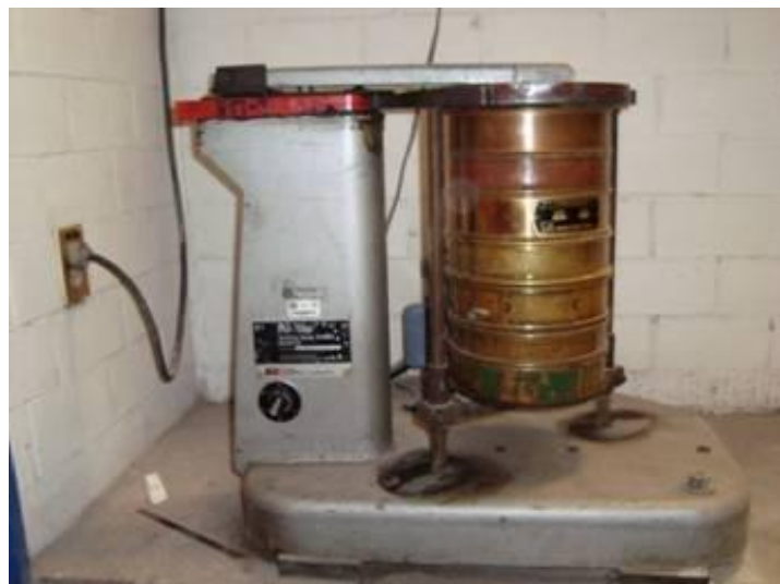
Figura 1.1 Ro-Tap empleado para la prueba granulométrica
