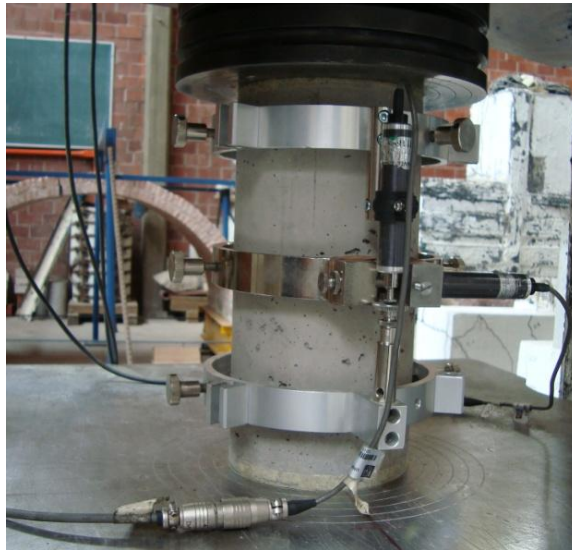
Figura 1.5 Compresómetro para determinar módulo elástico y relación de Poisson
