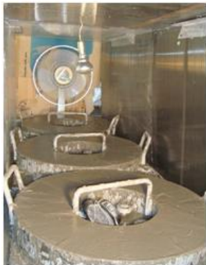
Figura 3 Configuración de la prueba de contracción plástica
