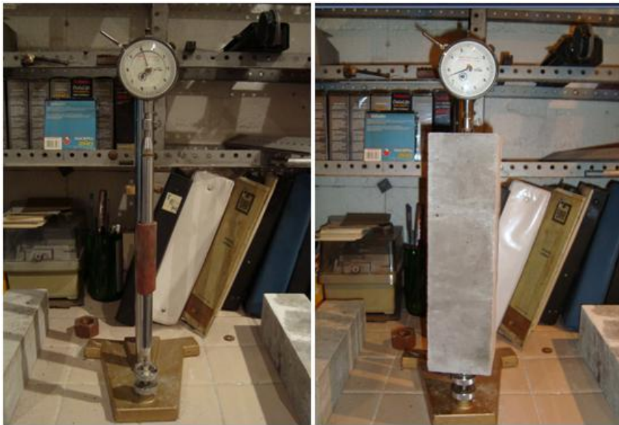
Figura 1.12 Dispositivo para la prueba de contracción por secado
