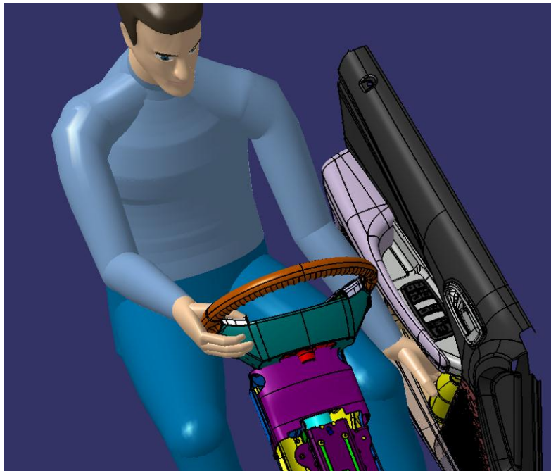
Fig. 14. Un modelo antropométrico 95 percentil es manipulado para verificar el alcance de la botella sin despegar la espalda del asiento
