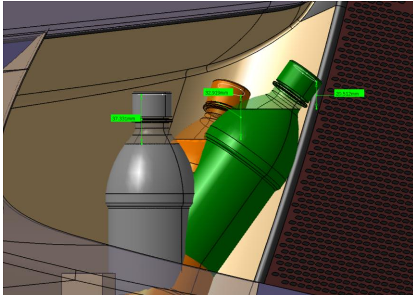
Fig. 13. Estudio de trayectoria de extracción de botella, simulando el comportamiento de su contenido
