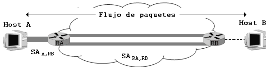
Figura III.16 Aplicación de IPSec en modo túnel
