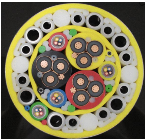
Figura 42. Sección transversal umbilical final del BC-10
