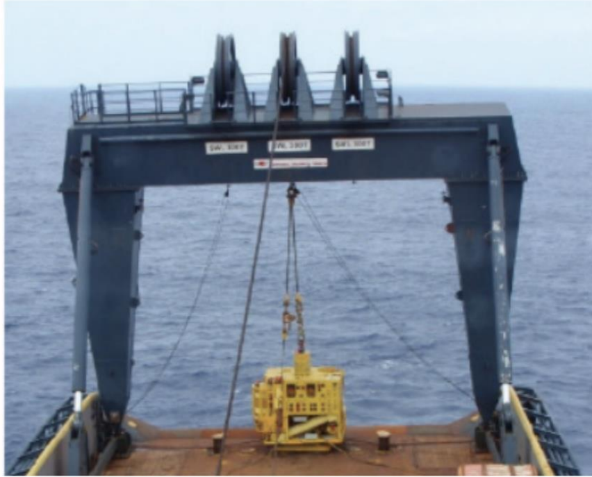
Figura 35. Sistema HCLS (despliegue de un árbol submarino)
