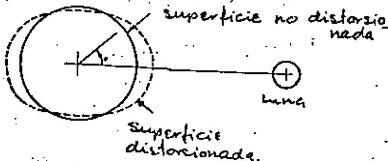
Si la luna gira sobre el plano ecuatorial de la tierra y considerando un punto de observación a una latitud,  $\phi$ , debemos proyectar el punto de observación al plano ecuatorial.
