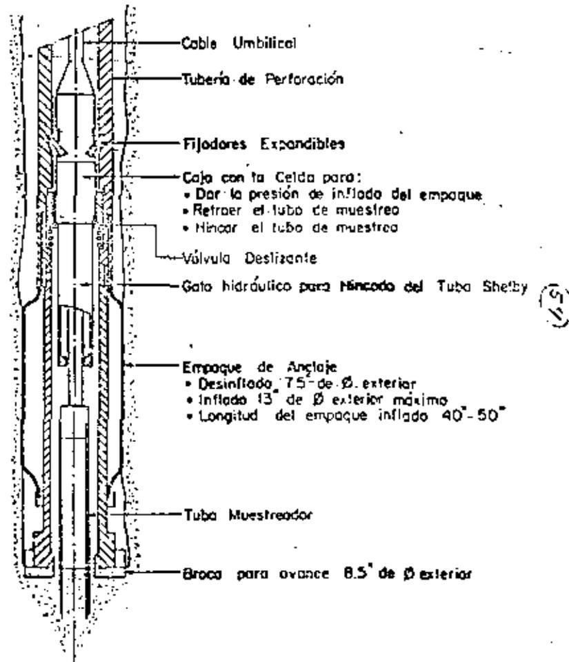
Fig. 2 SISTEMA DE MUESTREO INALTERADO WIP
