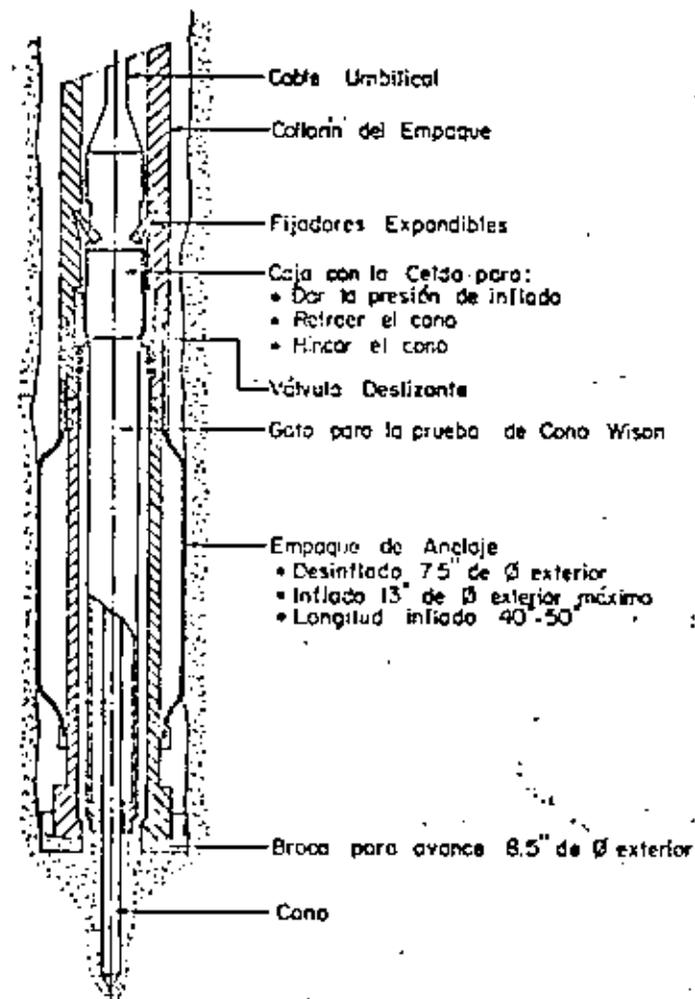
Fig. 3 SISTEMA WISON PARA PRUEBAS DE RESISTENCIA
