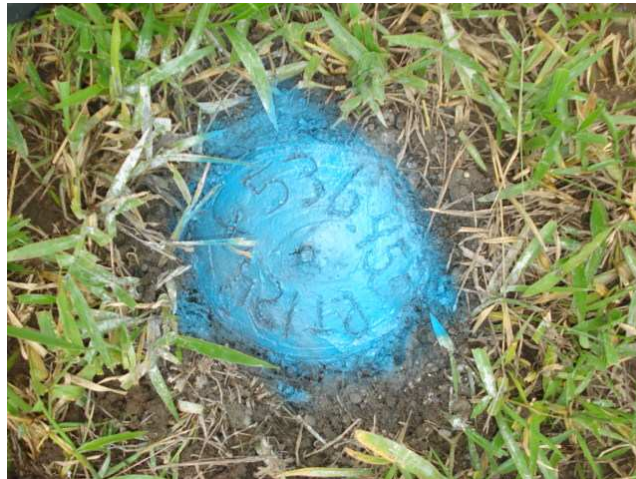
PT= 124+536.467 SOBRE MOJONERA VISTA A DETALLE
