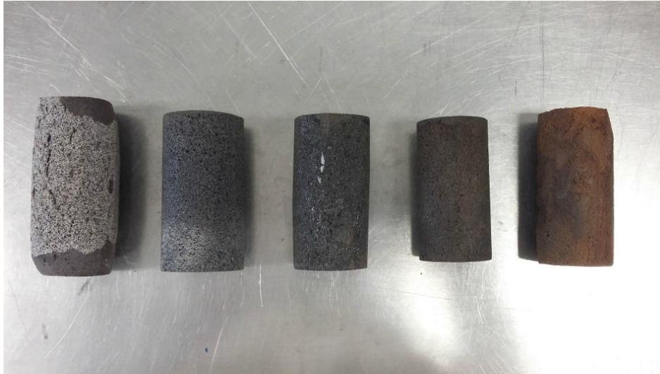
Figura A.8. Monitos fabricados con la fracción fina de las materias primas. De izquierda a derecha: A1 (0% lodos), B1 (30% de lodos), C1 (50% de lodos), D1 (70% de lodos) y E1 (100% de lodos).
