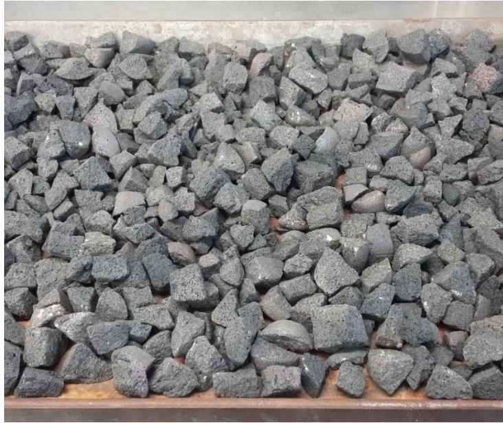
Figura A.10. Agregado vitrocerámico utilizado para la fabricación de los concretos ligeros estructurales. El tamaño máximo de partícula seleccionado fue de 19.1mm, como se expone en el texto. La trituración se realizó en una máquina trituradora de mandíbulas.
