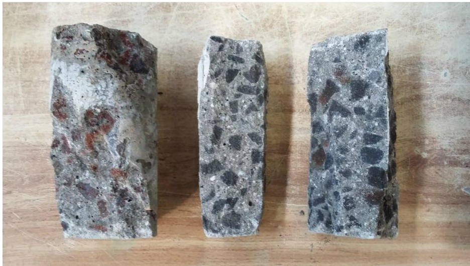
Figura A.11. Muestras de los concretos de agregados ligeros, se puede observar la distribución de las partículas de agregados dentro de la matriz del concreto. De izquierda a derecha: CLT, CRV y CRV2.
