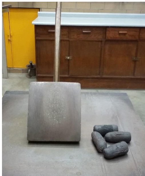
Figura A.9. Cuatro piezas de material vitrocerámico antes de la trititación. Esta es la forma que tenían las piezas luego de la calcinación.
