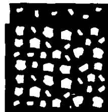
Recubrimiento con una capa de rodadura
