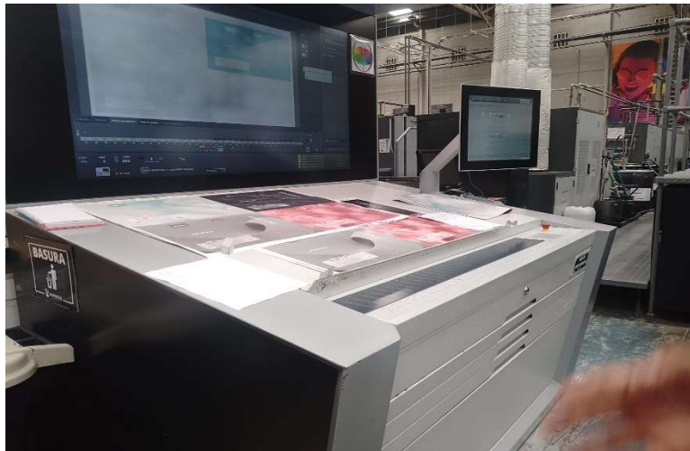
Figura 27. Tablero de control offset Heidelberg.
