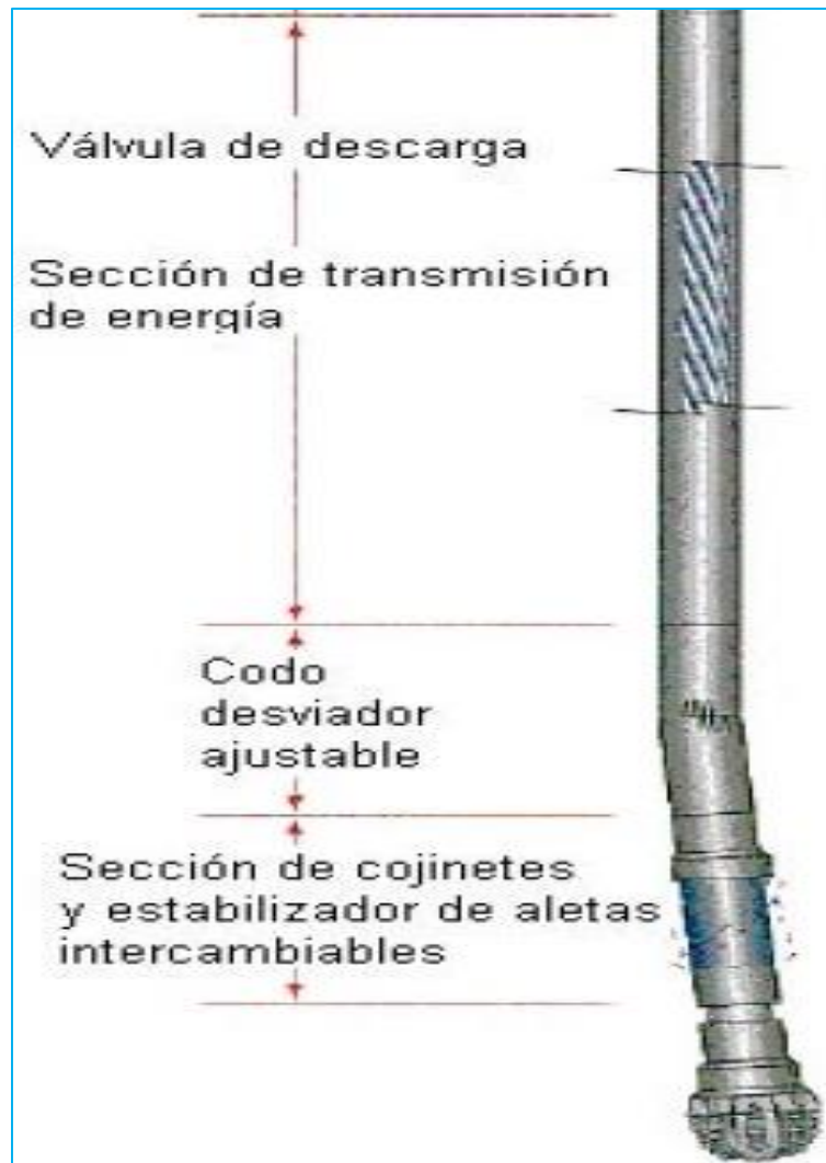
Figura 2.3 Herramientas deflexión. (Portal del petróleo, 2016).
