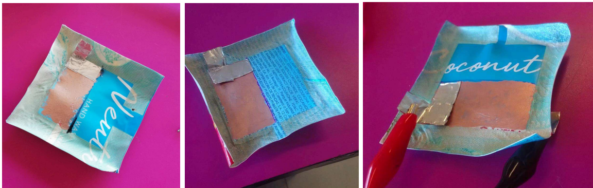
Figura 52 Carcasas selladas con grabadora/cortadora láser y posteriormente con plancha.
