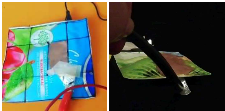
Figura 51 Carcasas hechas por termosellado con plancha.
