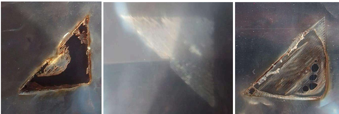
Figura 40 Pruebas con parámetros erróneos para el sellado.
