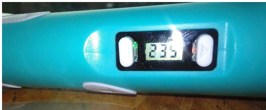
Figura 44 Pluma 3D con temperatura 235 para sellado de puntos de fuga.
