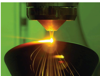
Figura 1.6. Sistema PF-LDED BeAM Magic 800 de Henry Royce Institute, capaz de imprimir un volumen de 1200 x 800 x 800 [mm] con 5 grados de libertad, utilizado para reparar componentes de la industria aeroespacial [11].
