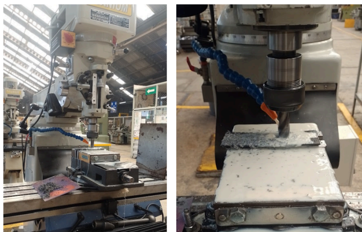
Figura 3.13 Fresadora vertical Titanium utilizada para todos los procesos de maquinado.
