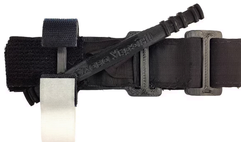
Figura 1.22. Torniquete reusable hecho por medio de manufactura aditiva como apoyo a Ucrania. Se realizaron pruebas Ultrasónicas para comprobar que el torniquete es capaz de frenar por completo el flujo de sangre, además, voluntarios en laboratorios de Polonia corroboraron que el torniquete es capaz de soportar 150 [lbs] en tracción [38].
