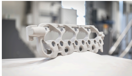
Figura 1.9. Patrón de fundición generado por ExOne por medio de un proceso de Binder Jetting [13].
