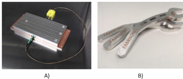
Figura 1.13. Piezas obtenidas por Fabrisonic mediante Manufactura Aditiva Ultrasónica. A) Termopar embebido dentro de una pieza impresa B) Llave Inglesa hecha de dos metales diferentes. [18]
