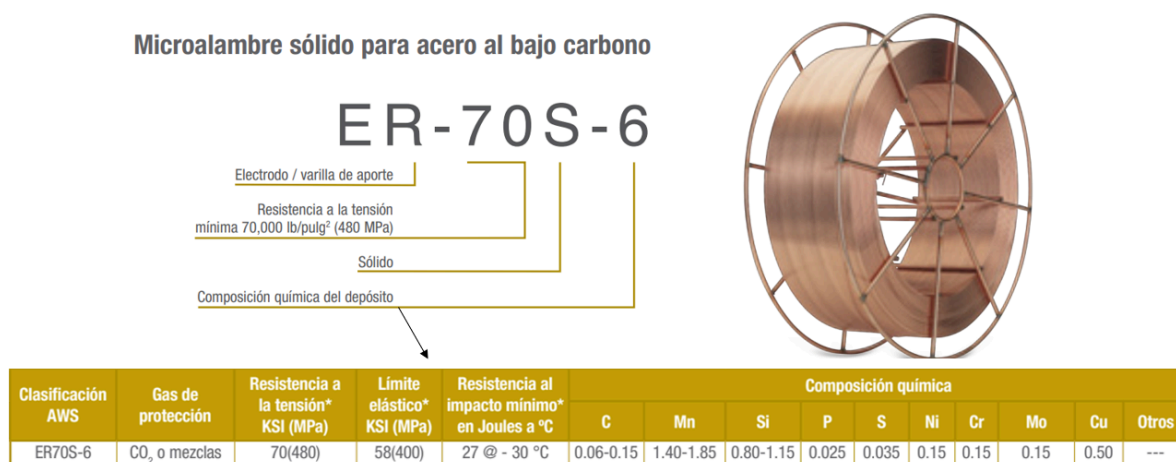
Figura 3.1) Nomenclatura y composición química del Acero ER70S-6. Tomado y modificado de [2].
