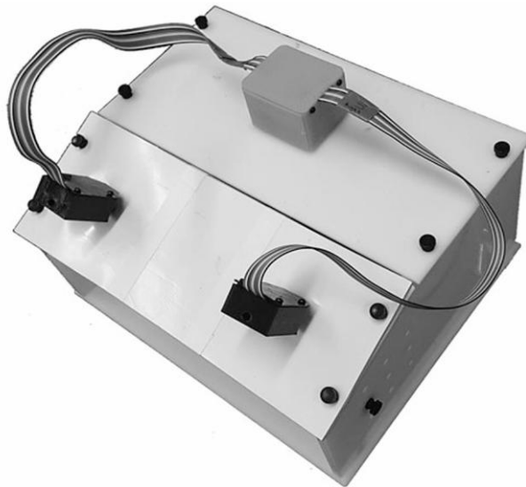
Figura 4 Simulador laparoscópico de caja completo de bajo costo y código abierto con ambos soportes ópticos instrumentados, completamente insertados en la caja. Gavrilovic et al., (2018).
