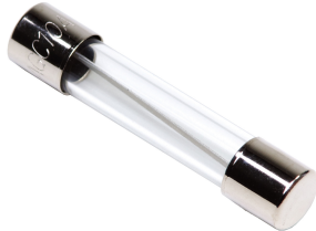
Figura 3.12: Fusible de tipo americano para corrientes de 5 [A].
