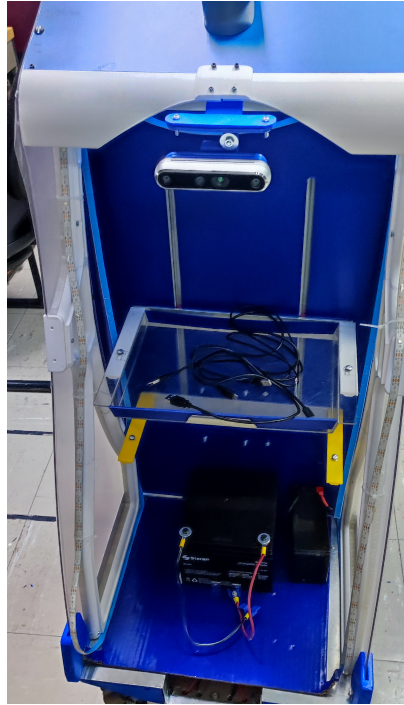
Figura 4.28: Robot con cámara intel realsense D455 fijada al robot.
