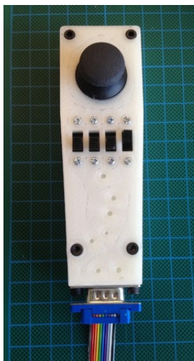
Figura 4.20: Diseño preliminar de mando para un único mando analógico con el componente "KY-023".
