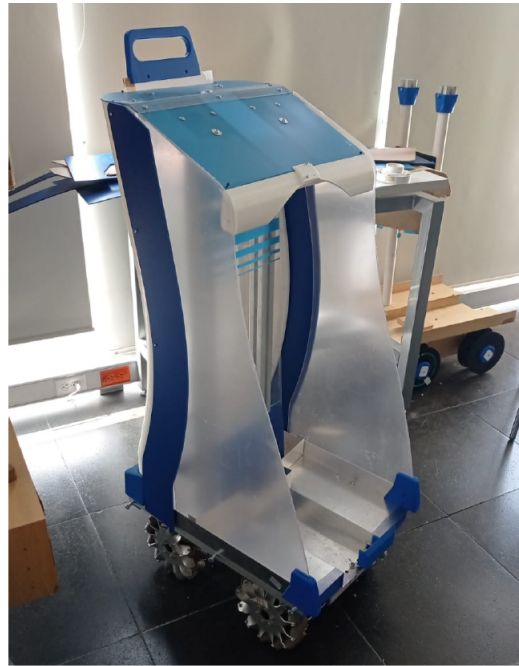
Figura 2.10: Primer versión del chasis y soporte del robot asistente. Imagen tomada desde el documento de Memoria técnica de AYUDAME 2.0.
