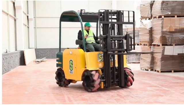
Figura 2.8: Ejemplo de un montacargas industrial con ruedas mecanum .
