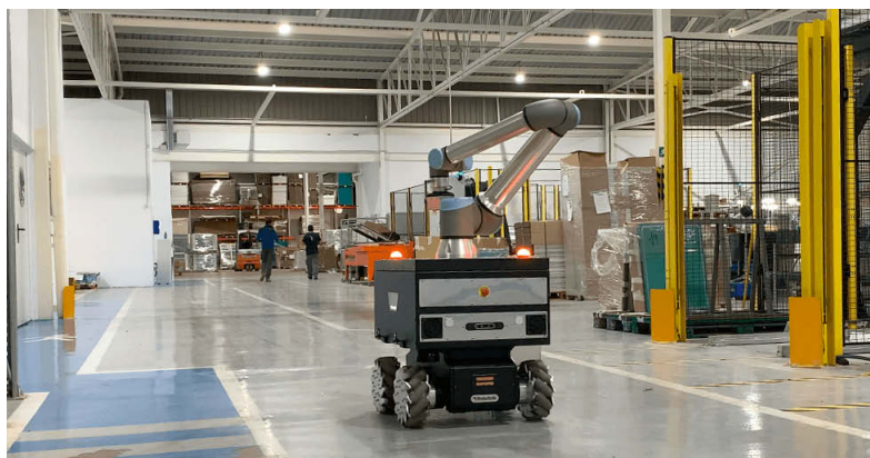
Figura 2.4: Ejemplo de un robot móvil omnidireccional con brazo robótico.
