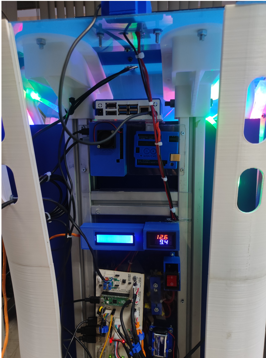
Figura 4.39: Propuesta de tablero de configuración electrónica final con prospectos de cambios del robot Ayudame 2.0.
