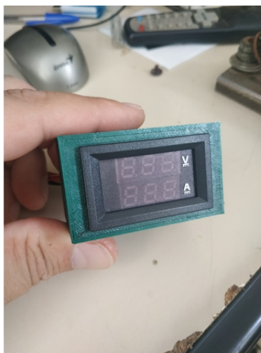
Figura 4.19: Visión preliminar de una caja protectora para un voltímetro amperímetro. Este diseño fue realizado por el usuario Marco EmmeTi, diseño disponible en la URL: " https://www.thingiverse.com/marcomt/designs ".
