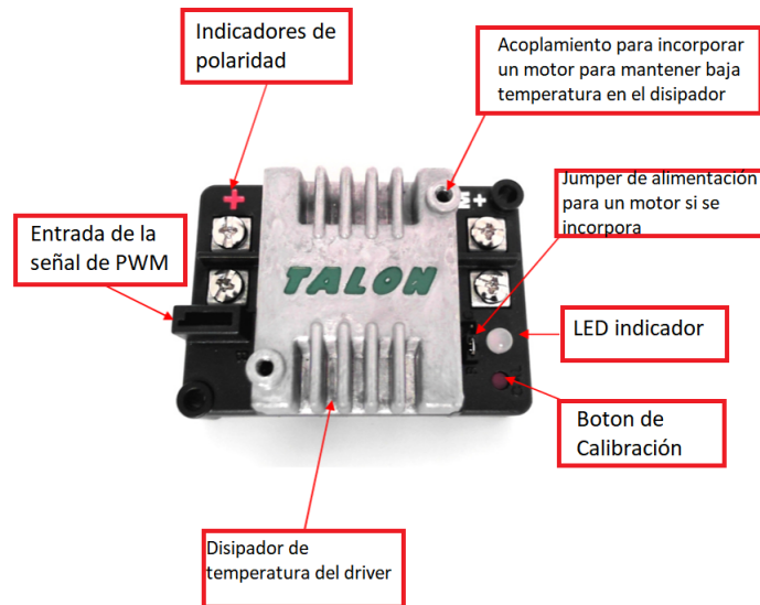
Figura 2.14: Controlador de motores de corriente directa modelo Talon SR
