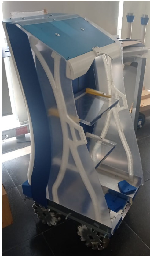
Figura 2.11: Segunda versión del chasis y soporte del robot asistente. Imagen tomada desde el documento de Memoria técnica de AYUDAME 2.0.
