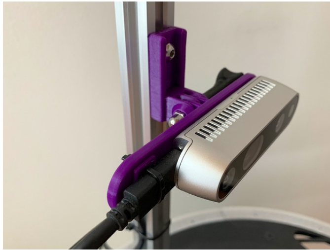
Figura 4.16: Soporte para la camara Intel Realsense D455. Este diseño fue realizado por el usuario Bradley BeMent y se encuentra disponible en el siguiente URL: " https://www.thingiverse.com/vatbrain/designs ".
