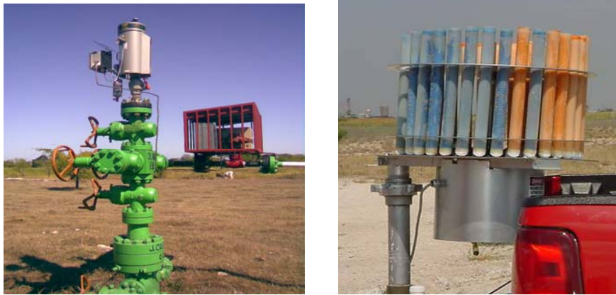
Figura 4.10 Pozo con lanzador de barras Automático.
