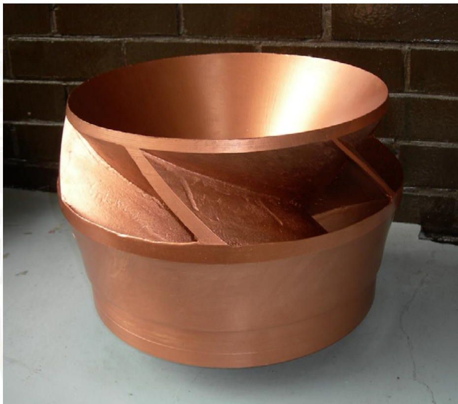
FIGURA 2.9 IMPULSOR DE FLUJO MIXTO
