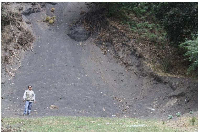
Figura 4.47. Fotografía E de la Zona 4, se puede ver la composición de la ladera y el deslizamiento que ya se presenta en la zona de ceniza.
