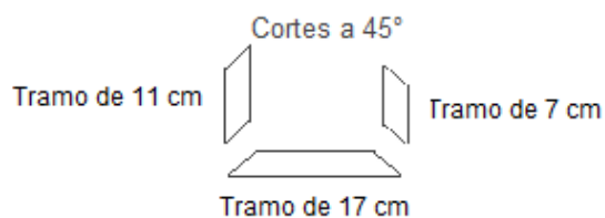
Figura 56. Medidas y ángulos de los tramos a ensamblar para rodear la columna del centro de servicio.
