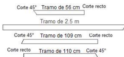
Figura 63. Medidas y ángulos de los tramos a ensamblar, pegados a concreto en el almacén
