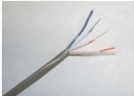
Figura 110. Corte del cable telefónico para ponchar en la regleta siemon
