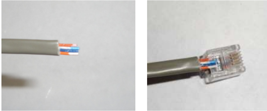
Figura 84. Corte de cable telefónico
