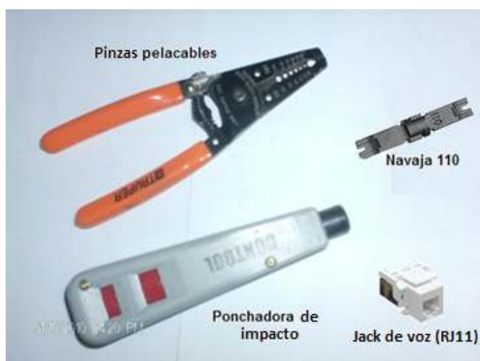
Figura 78. Material para colocar el conector RJ11.
