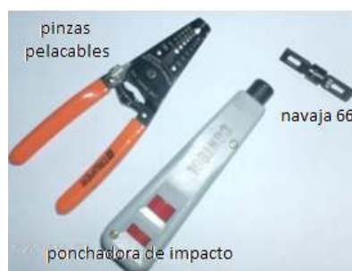
Figura 102. Pelacables y ponchadora con navaja S66
