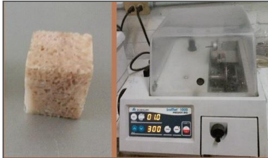
Figura 4.10 Muestra cubica de hueso trabecular de vértebra y cortadora de disco de diamante.
