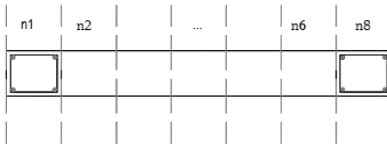
Figura 6.11 División del muro en elementos verticales
