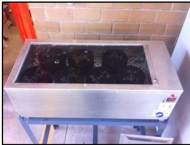
Figura 3.4.2.3. Inmersión en agua caliente por 24 horas.
