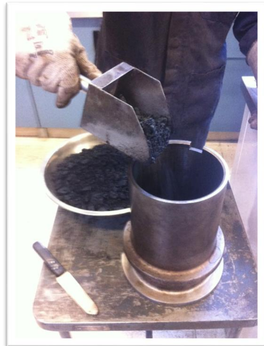
A 1.14 Etapa de digestión del caucho en la mezcla asfáltica y colocación en los moldes de compactación
