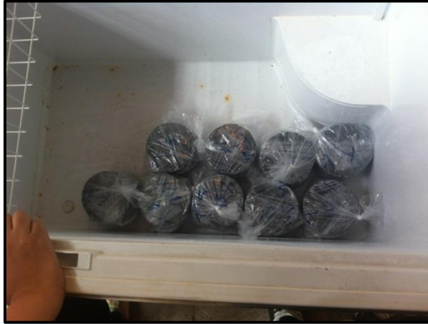
Figura 3.4.2.2. Congelamiento a -18^{\circ}\text{C} por 16 horas.
