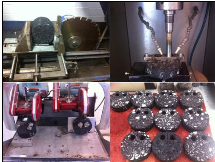
Figura 3.3.3.2. Geometría de las probetas para la prueba de fractura.
