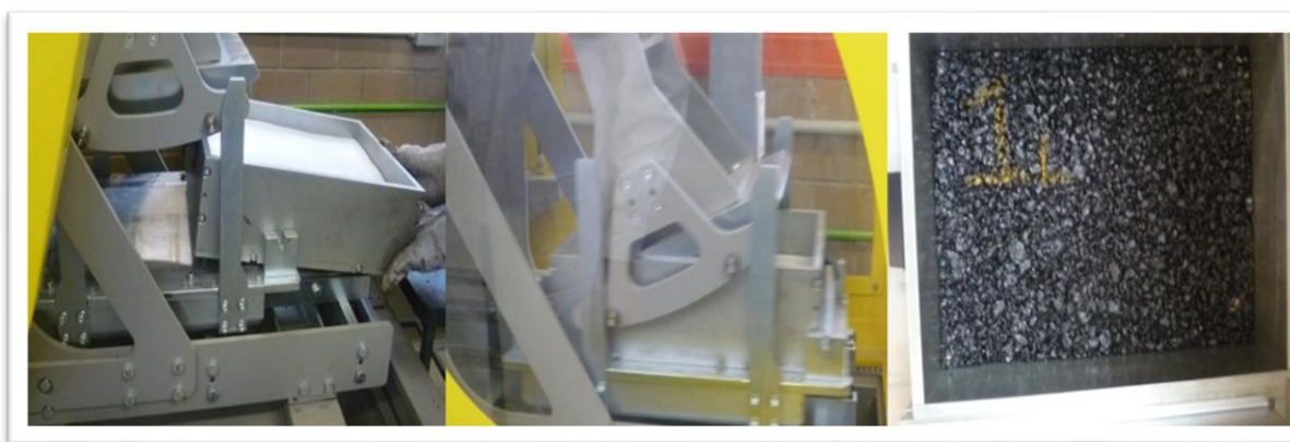
A 1.17 Compactación de probetas para la prueba de deformación permanente
