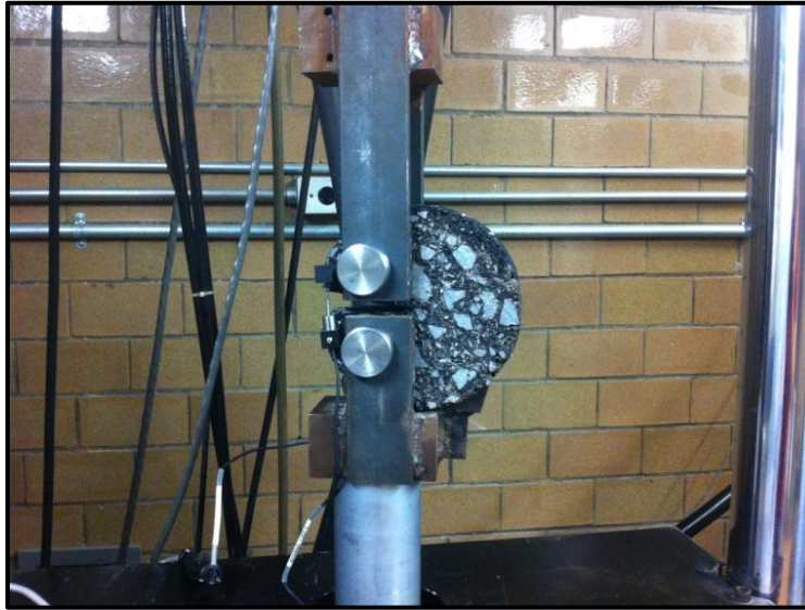
Figura 3.5.2.1. Colocación de la probeta en el dispositivo de ensayo.
