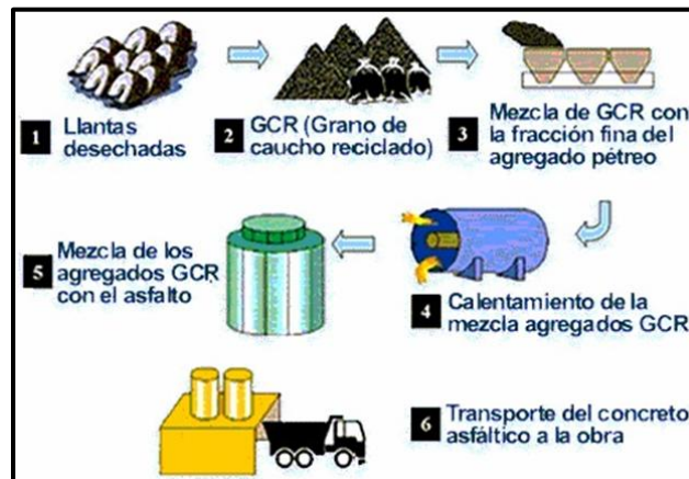
Figura 2.3.1.2. Proceso de modificación por vía seca [15].
