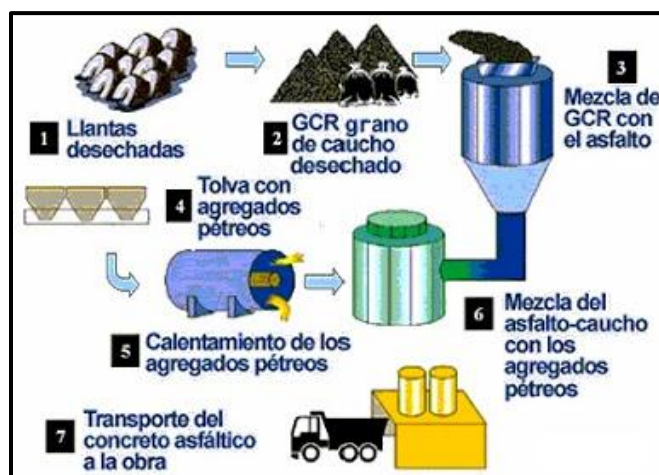
Figura 2.3.1.3. Proceso de modificación por vía húmeda [15].
