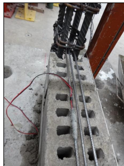
c) Tres varillas de refuerzo horizontal en la junta. La varilla de la izquierda esta instrumentada.
