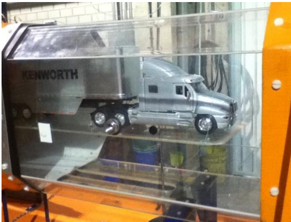
Fig. 5.15 Modelo de tractocamión con deflector de aire modificado tipo (media concha).
