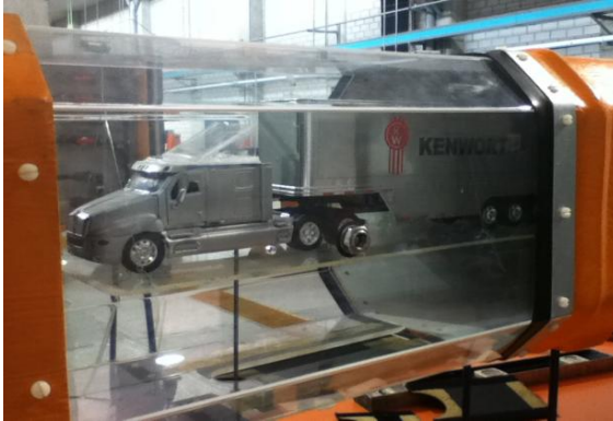
Fig. 5.11 Pruebas preliminares en tunel de viento con modelo de tractocamión. Con deflector a 31 grados.
