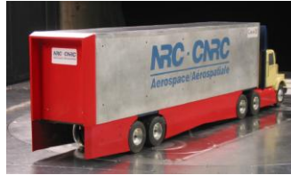
Fig. 5.33 Paneles de extensión biselados 15°
