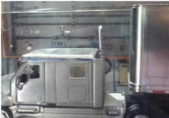
Fig. 5.10 Prueba de modelo tractocamión sin deflector de aire a una velocidad de 14 m/s
