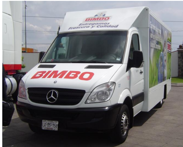
Fig. 6.6 Deflector de aire en vehículo de reparto
