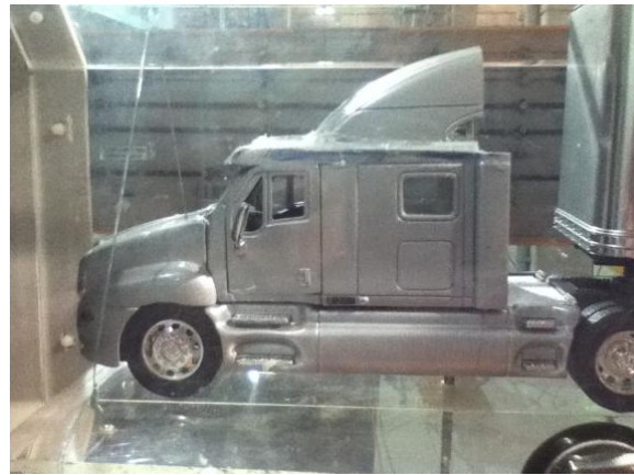
Fig. 5.16 Prueba de modelo tractocamión a 14 m/s
