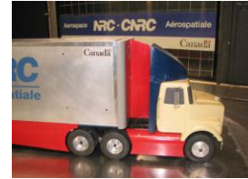
Fig. 5.34 Estabilizador de vórtices
