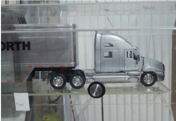
Fig. 5.7 Modelo de tractocamión y caja, pruebas preliminares
