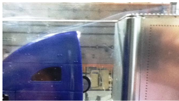
Fig. 5.21 Deflector de aire tipo concha completa a una velocidad de 4 m/s
