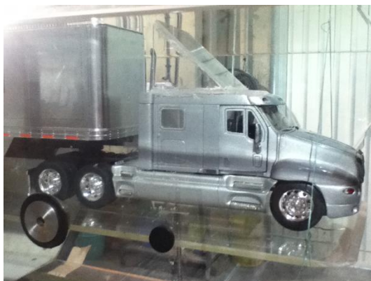
Fig.5.13 Modelo de tractocamión con deflector a 41°.
