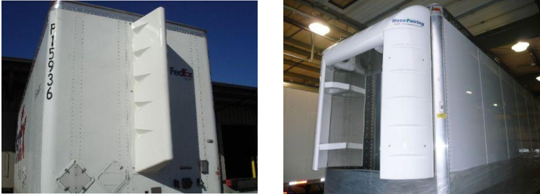
Fig. 1.9 Estabilizador de vórtices
