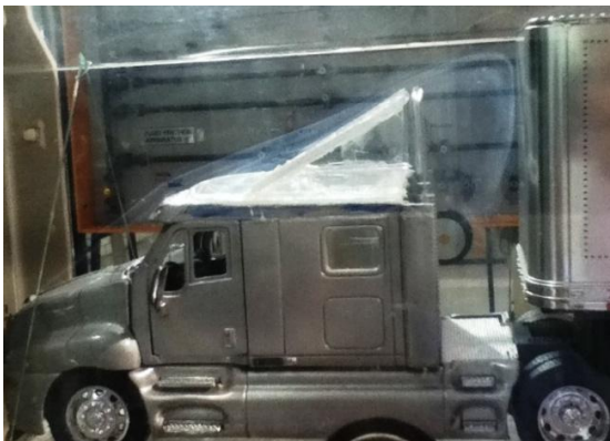
Fig. 5.24 Deflector de aire a 31^\circ a una velocidad de 2 m/s
