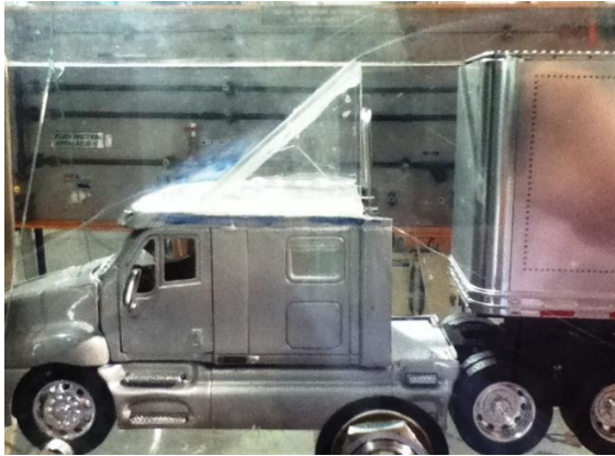
Fig. 5.26 Deflector de aire a 41^\circ a 3 m/s
