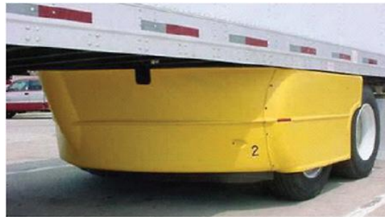
Fig. 1.10 Cubierta tipo bogie [7]
