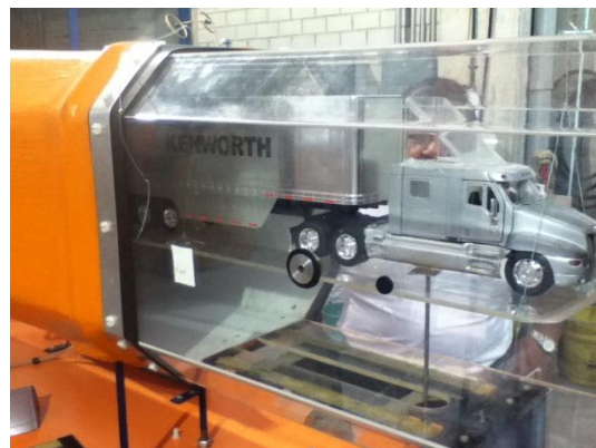
Fig. 5.14 Prueba de modelo tractocamión a 14 m/s
