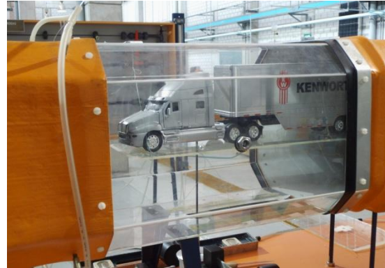
Fig. 5.8 Modelo de tractocamión y caja 14 m/s
