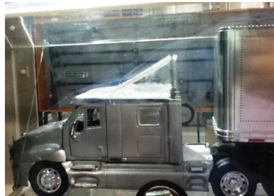
Fig. 5.25 Deflector de aire a 31^\circ a una velocidad de 4 m/s
