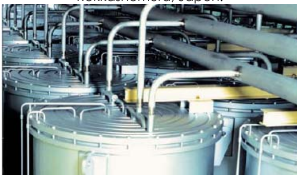
Figura 32. Cascada de centrifugadoras en Rokkashomura, Japón.
