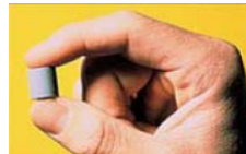
Figura 34. Pastilla de combustible típica.
