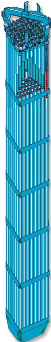
Figura 33. Ensamblaje típico BWR.
