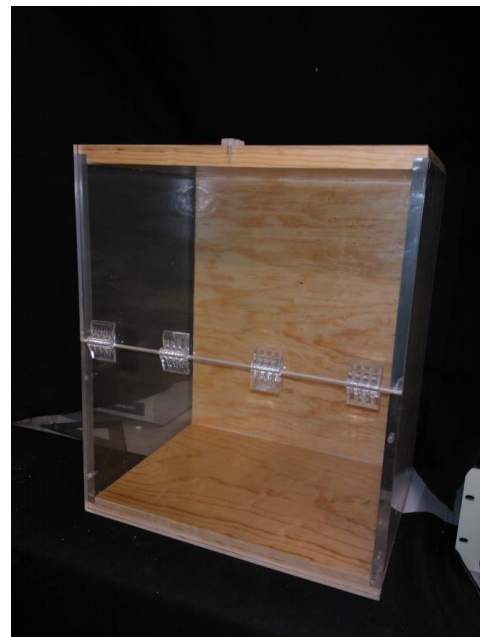
Figura 3.8. Caja de madera y acrílico para aislar el dispositivo de electrohilado.
