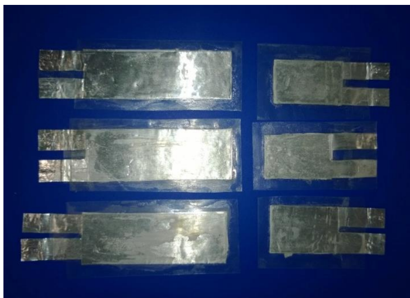
Figura 4.3. Celdas piezoeléctricas, malla de PEO 750 al 6% w/w en etanol/agua (80/20) con partículas de cuarzo (50% w/w respecto al PEO 750 ), electrodos de aluminio (izquierda 6x2 cm, derecha 3x2 cm) y encapsulado en Mylar.
