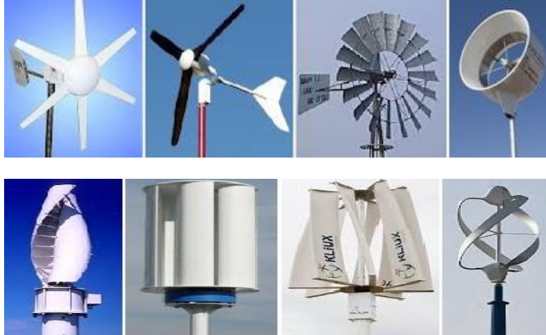
Figura 3.2 HAWT (superior) y VAWT (inferior).
