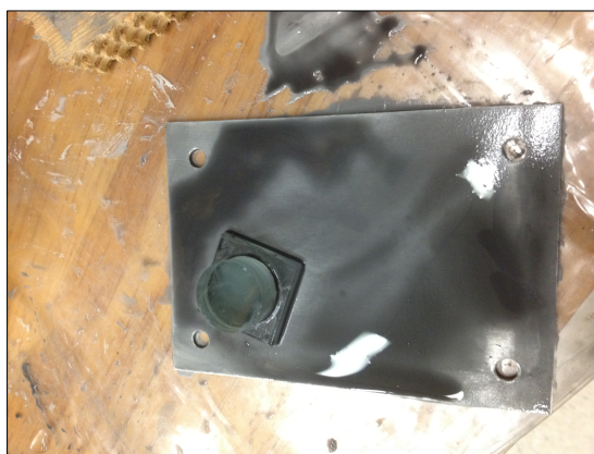
Figura 36: Pulido de placas con abrasivo de 220 \mu\text{m}
