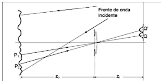
Figura 18: Sistema óptico y diafragma circular (speckle subjetivo).
