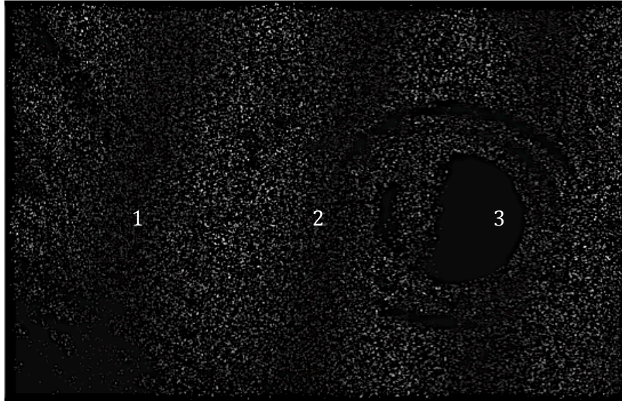
Figura 57: Franjas de interferencia obtenidas en la esquina inferior izquierda para el eje x
