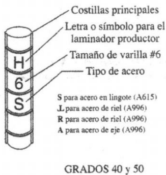
Figura 4.23. Marcas de identificación para varilla estándar ASTM, cortesía del Concrete Reinforcing Steel Institute (McCormac, Brown).
