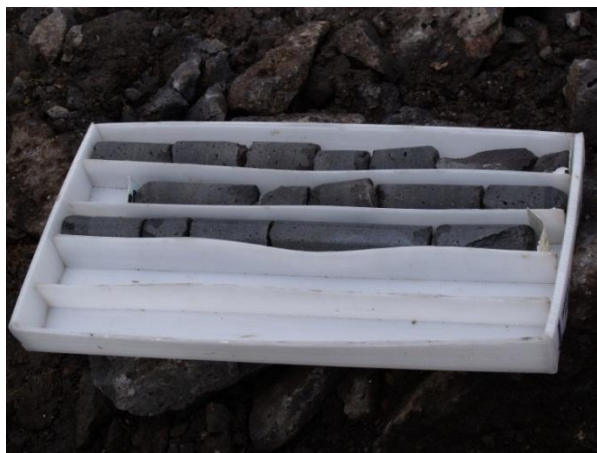
Figura 3.15. Muestras obtenidas mediante sondeo con equipo rotatorio.
