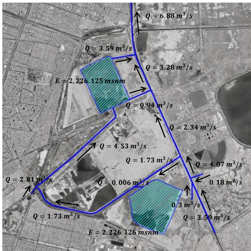
Fig 4.15 Resultados de la afinación de las condiciones iniciales del sistema hidráulico
