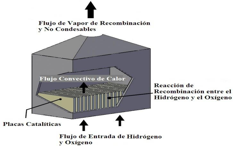
Figura 6. Recombinador Autocatalítico Pasivo
