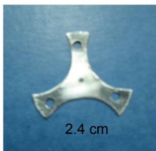
Figura 3.8. Gasket de acero inoxidable de 2.4 cm de diámetro y espesor de 500 \mu\text{m} , utilizado en la DAC.
