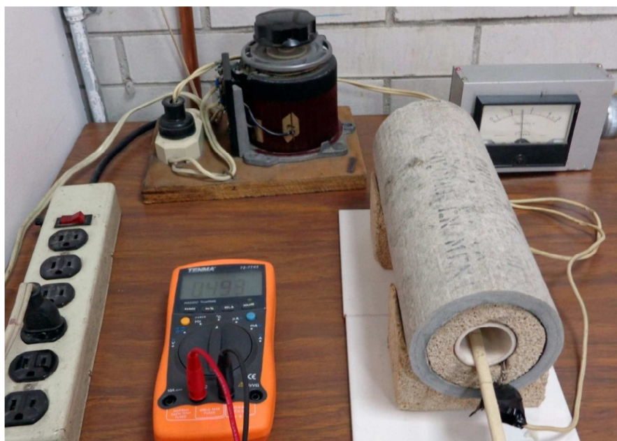
Figura 4.2. Imagen que muestra el horno utilizado en el tratamiento térmico.
