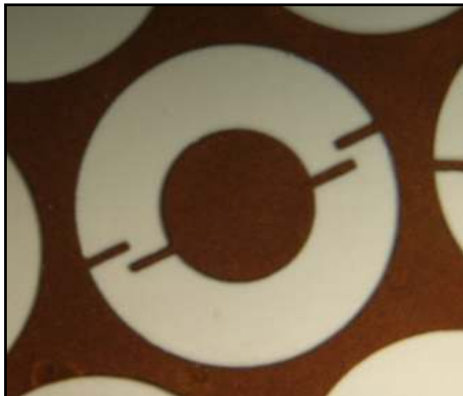
Figura 4.4. Sección de un elemento de antena lente fabricado mediante fotolitografía.
