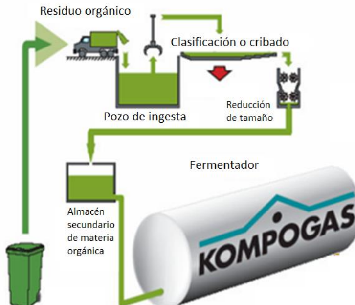
Figura 3.5. Proceso KOMPOGAS (Adaptado de KOMPOGAS, 2010).
