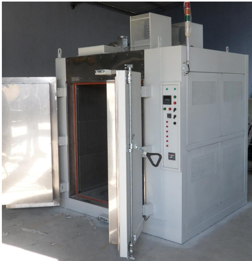
Se instalan los empaques en puerta y marco.
