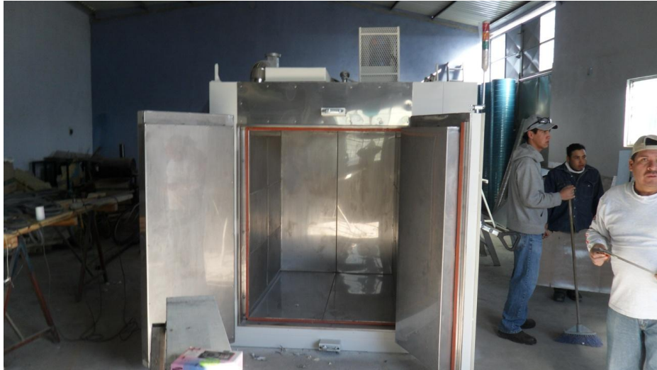
Se instalan los empaques en puerta y marco.
