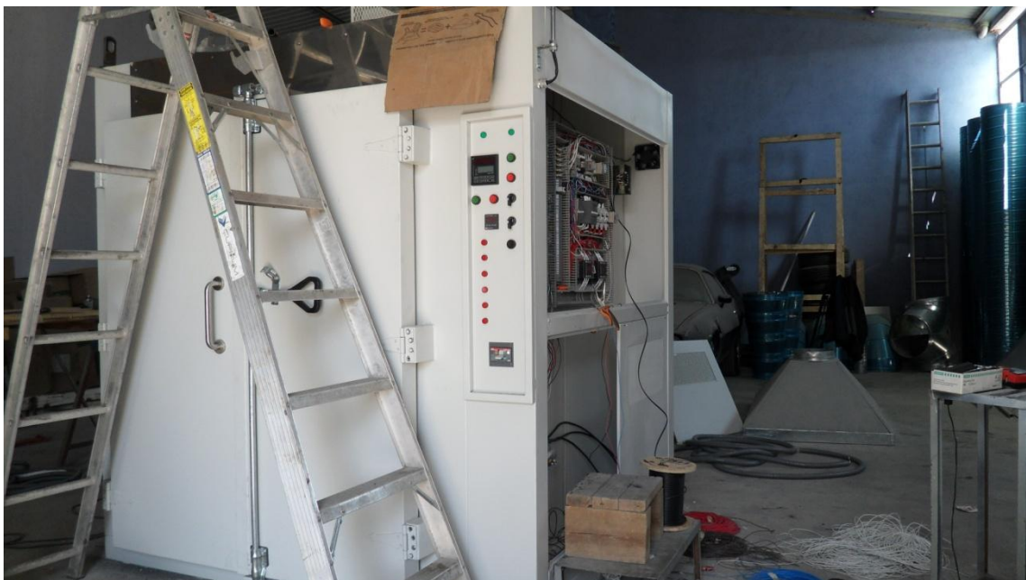
5. Se muestra el control de temperatura, control de límite de temperatura y los botones de control.
