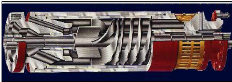
Fig. 1.10 Separador de gas 31 .
