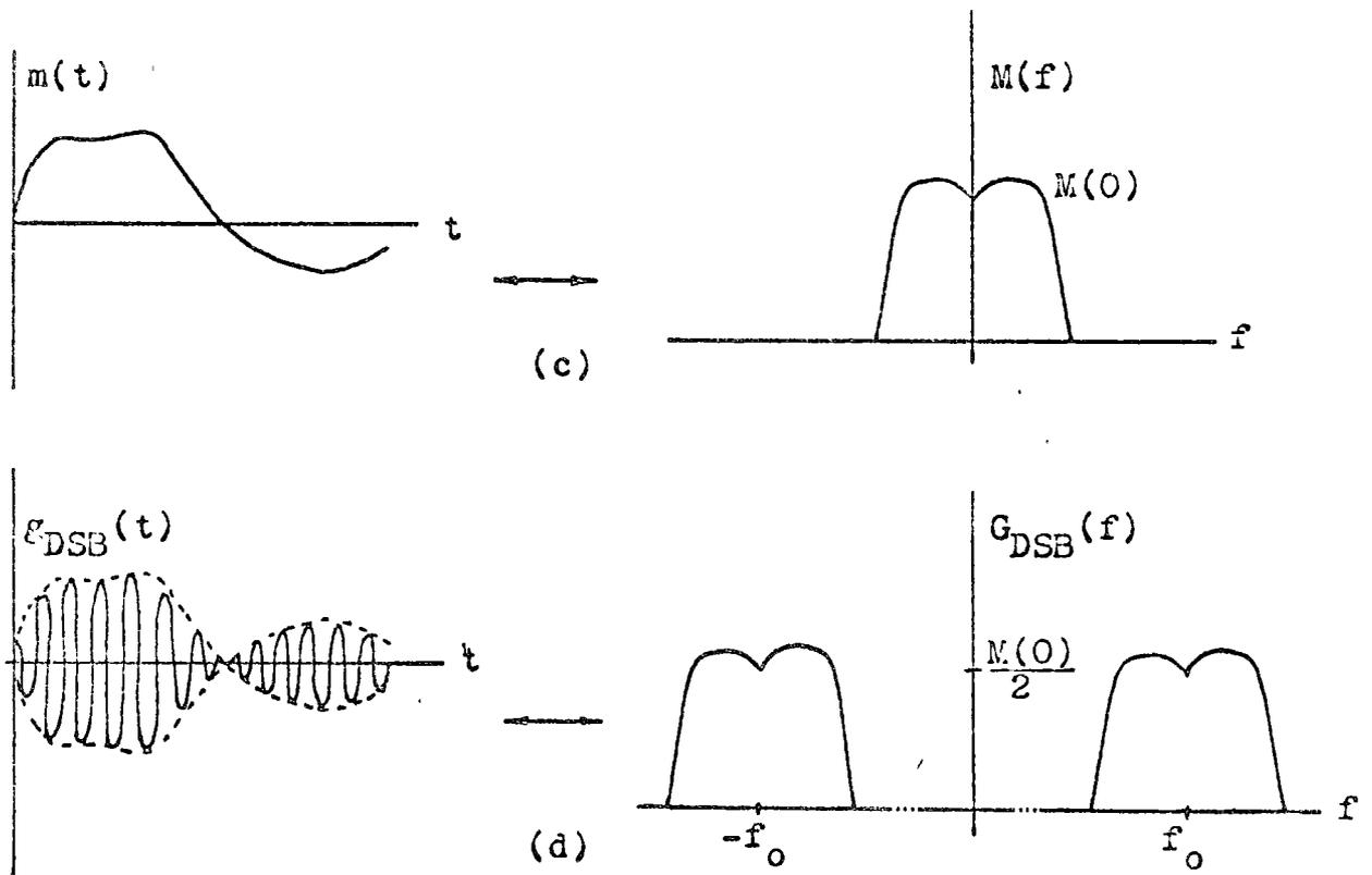
Fig. 2.8 Modulación y demodulación en DSB a) Modulación, b) demodulación, c) señal y espectro de  $m(t)$ , d) señal y espectro de DSB.
