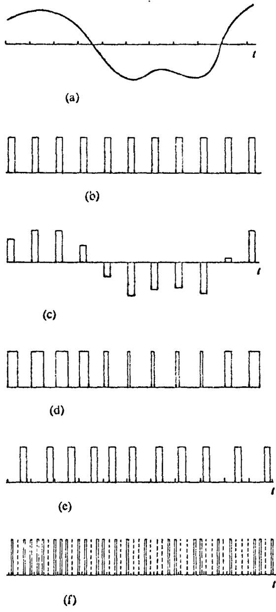
FIG. 3.1.1 TIPOS DE MODULACION POR PULSOS
