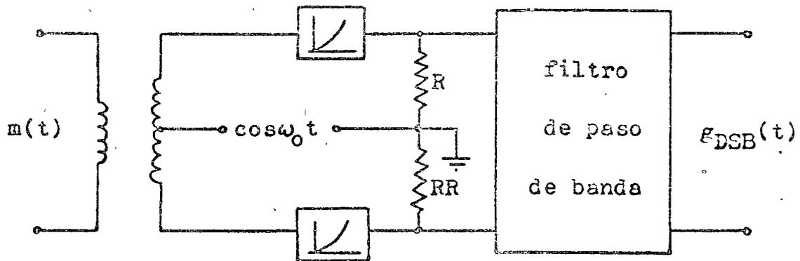
Fig. 2.10 Modulador cuadrático balanceado
