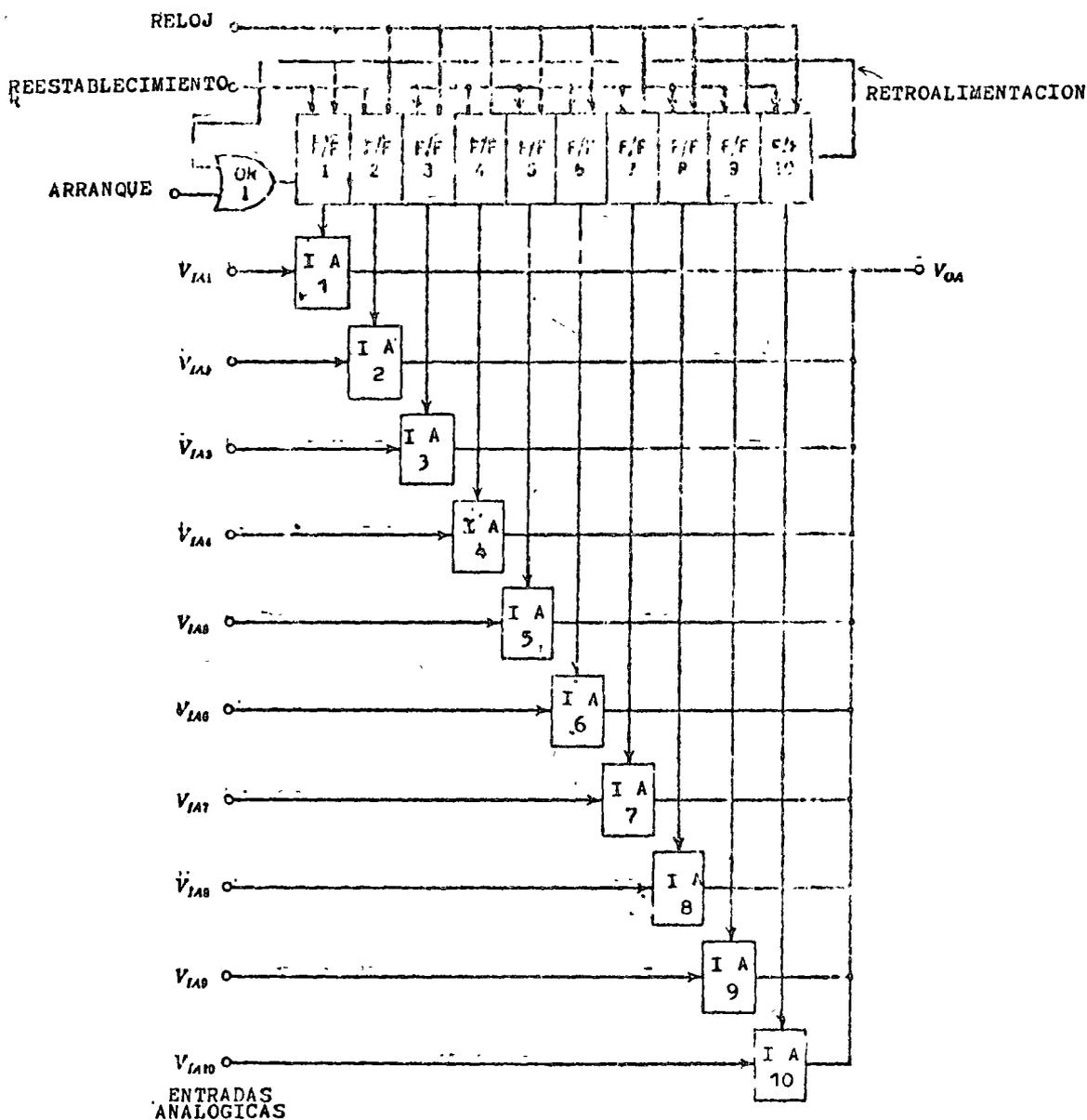
FIG. 3.3.4 MULTICANALIZACION POR MEDIO DE UN CONMUTADOR CONTROLADO
