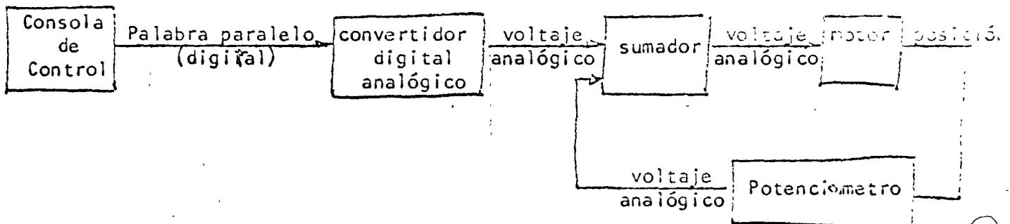
En este ejemplo el sumador puede ser digital y el potenciómetro substituirse por una rueda codificada, realizando en este caso la conversión digital analógica antes del servo motor.
