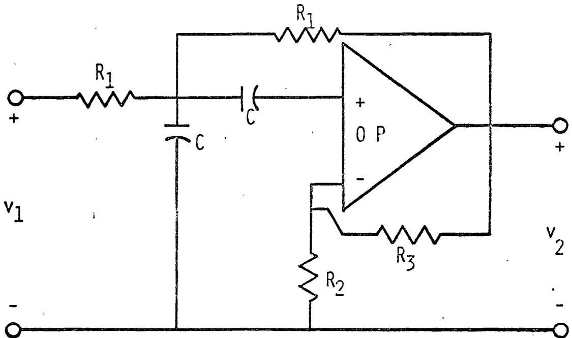
CIRCUITO PROTOTIPO DE UN FILTRO PASO BANDA DE SEGUNDO ORDEN
