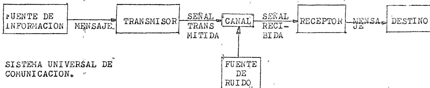
El ruido es un disturbio aleatorio siempre presente en todo Sistema de Comunicación, que se añade a la señal deseada. Su presencia tiende a impedir la recepción de la señal deseada y es un factor limitante en su detección, por lo que es determinante en el funcionamiento del Sistema. Otro factor importante es la interferencia producida por otras señales transmitidas.
