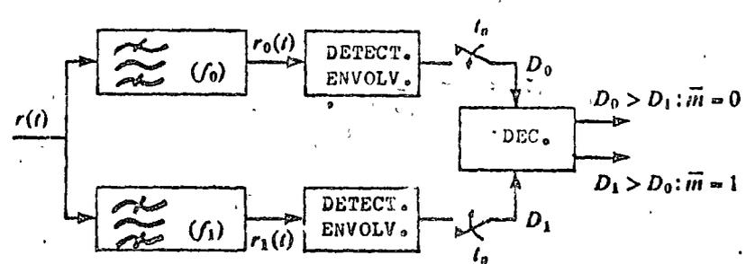
FIG. 3.4.6 MODULACION DIGITAL EN FRECUENCIA
