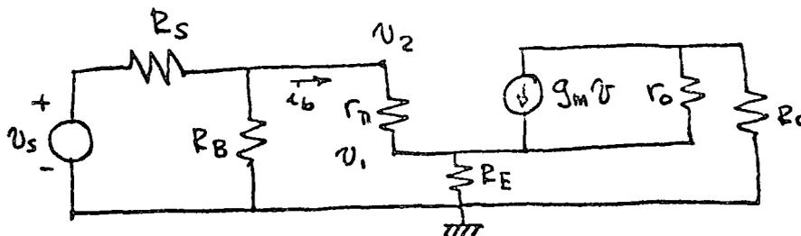
$$R_B = R_1 // R_2, \quad v = V_2 - V_1$$
