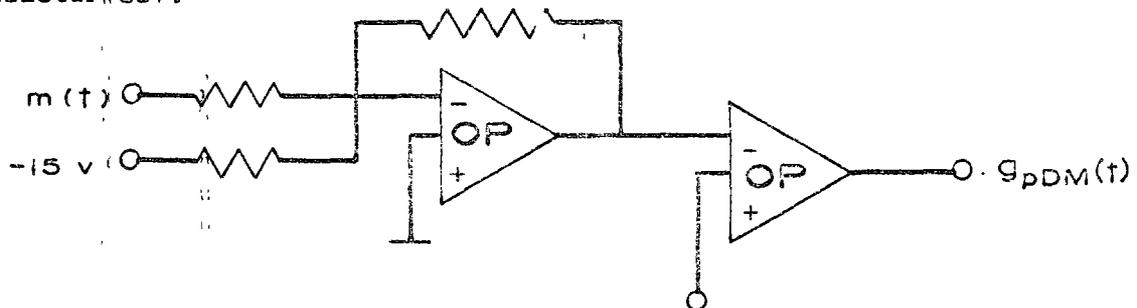
Fig. 2 Modulador por duración de pulso
