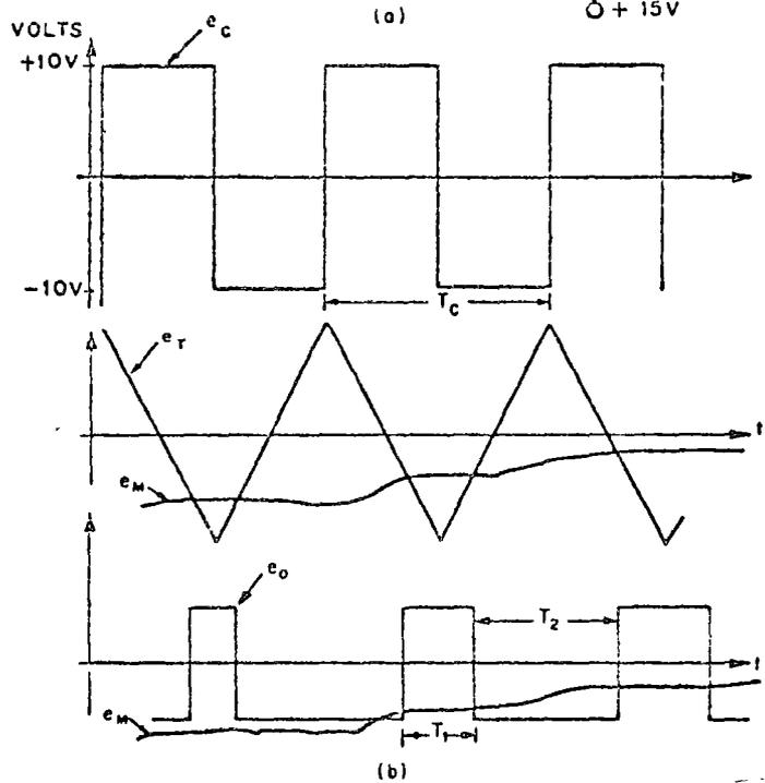
FIG. 3.1.5 MODULADOR POR DURACION DE PULSOS
