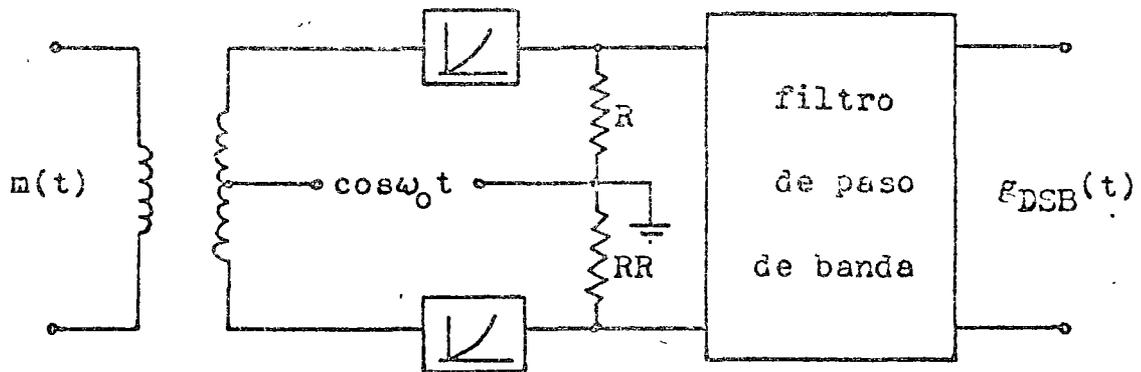
Fig. 2.10 Modulador cuadrático balanceado
