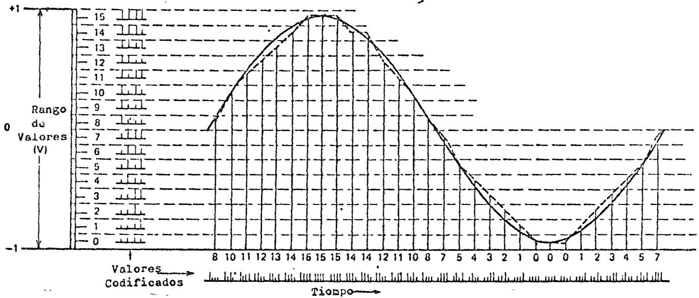
FIG. 3.2.2 CUANTIZACION Y CODIFICACION RESULTANTE UTILIZANDO 16 PASOS CUANTICOS
