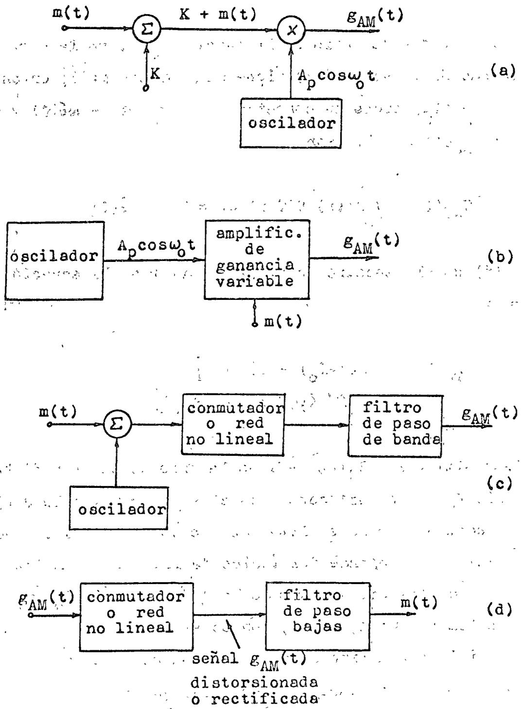
Fig. 2.1 La modulación en amplitud a) El proceso de modulación, b) amplificador modulador de ganancia variable, c) modulador no lineal, d) el proceso de demodulación.
