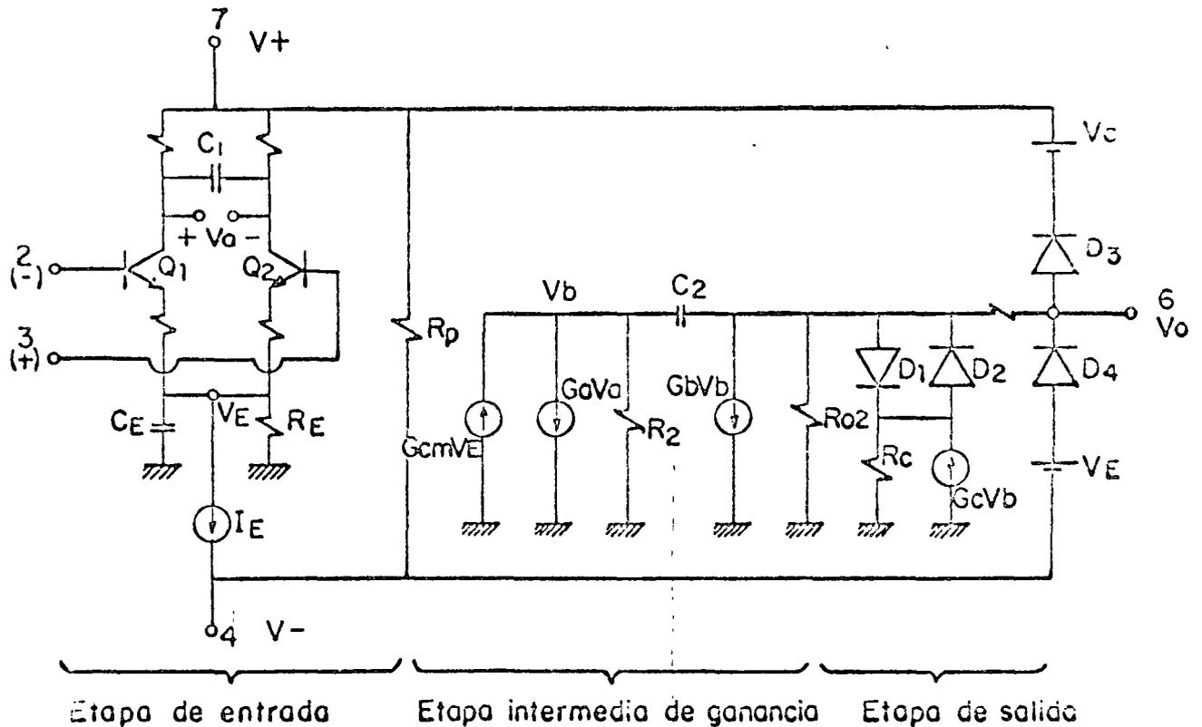
Fig 4.2 Macromodelo del amplificador operacional ICL 8741.
