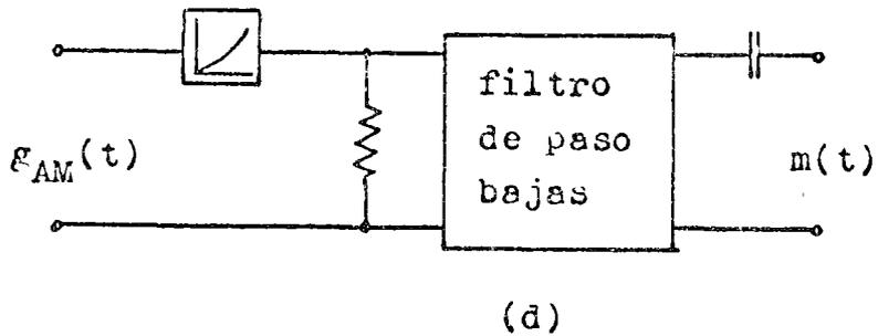
Fig. 2.7 Modulación cuadrática a) Sistema no lineal, b) característica, c) modulador cuadrático, d) demodulador cuadrático.
