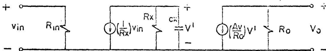
Fig. 4.1. Modelo elemental de un amplificador operacional.
