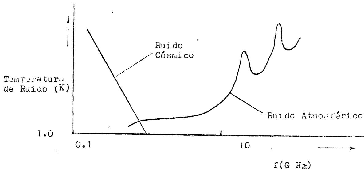
La radiación cósmica y la perturbación atmosférica generalmente se introducen al Sistema por la antena receptora. El primero comprende principalmente radiaciones electromagnéticas del sol y fuentes galácticas. Su efecto directo puede reducirse apuntando adecuadamente la antena.
