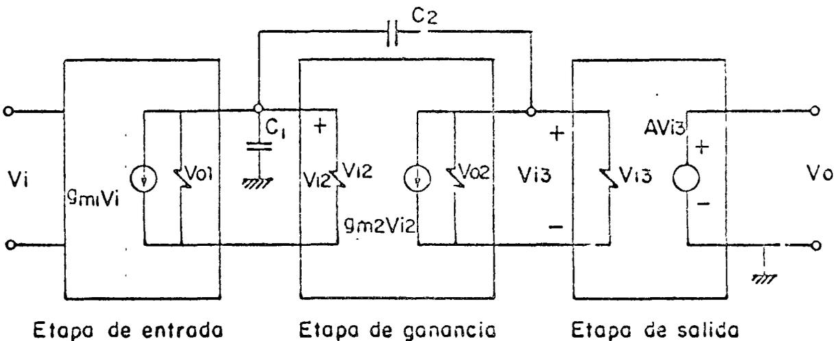
Fig. 3.7. Modelo para calcular frecuencia de corte
