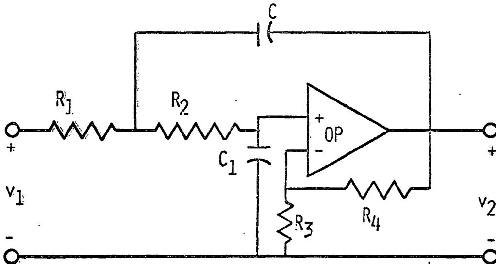
CIRCUITO PROTOTIPO DE UN FILTRO PASO BAJOS DE SEGUNDO ORDEN
