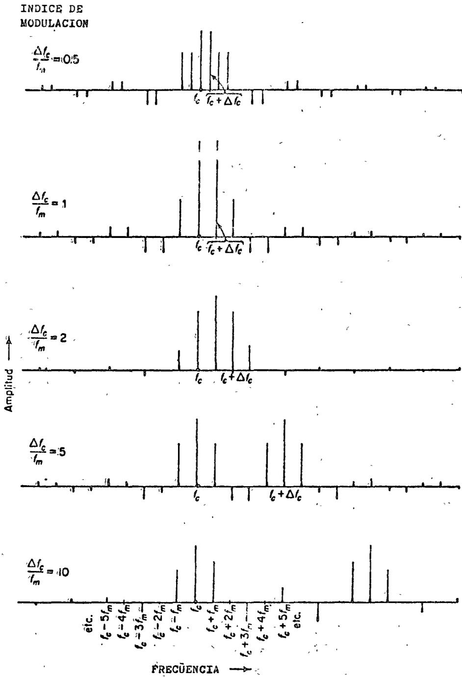
FIG. 3.4.7 ESPECTRO DE FSK PARA LA SECUENCIA 01010101 ...
