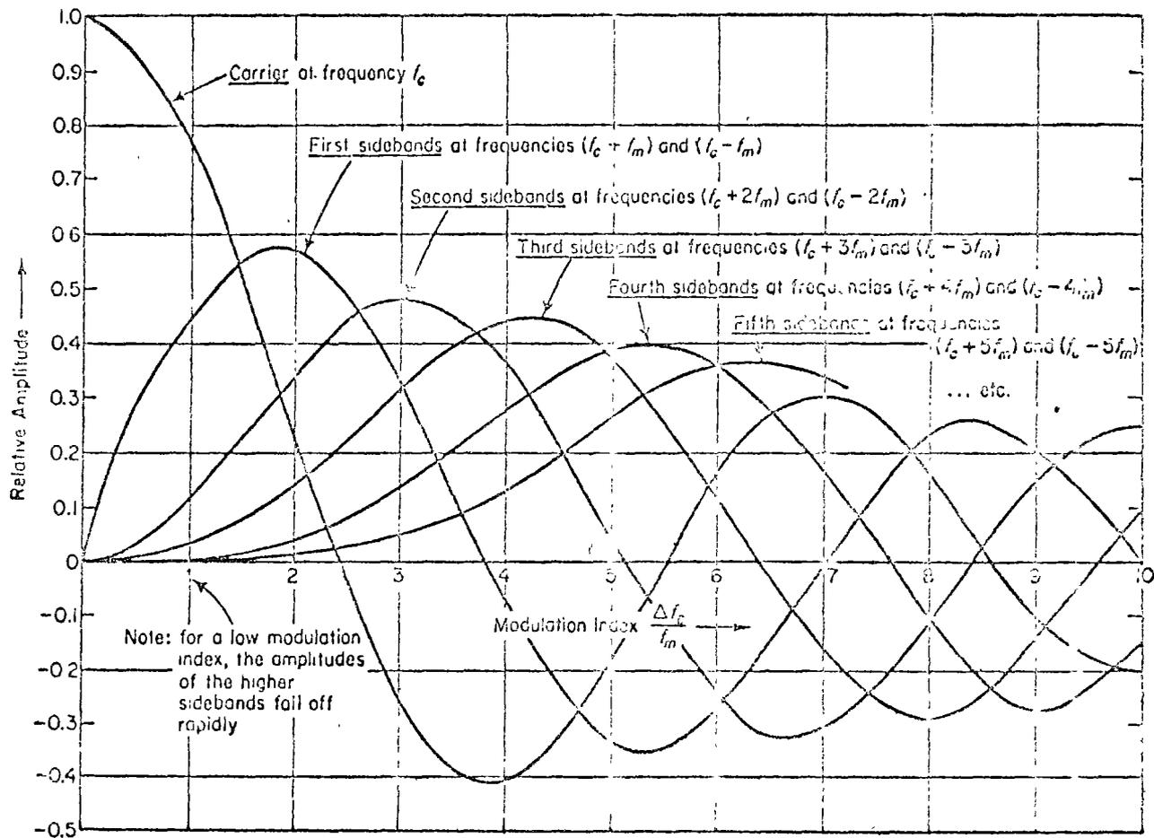
Componentes Espectrales de una Señal FM
