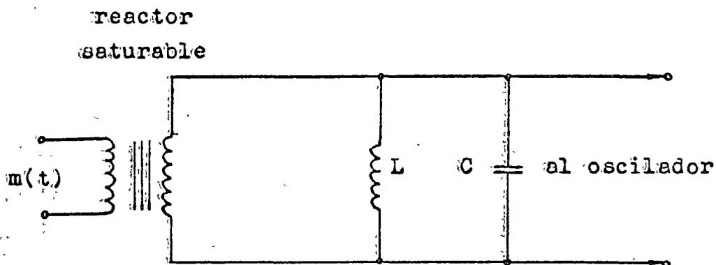
Fig. 2.16 Modulador de FM de reactor saturable
