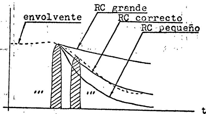
Fig. 2.5 Detector de envolvente a) Circuito, b) forma de onda, c) efecto de la constante de tiempo RC en la reconstrucción de la señal  $m(t)$ .
