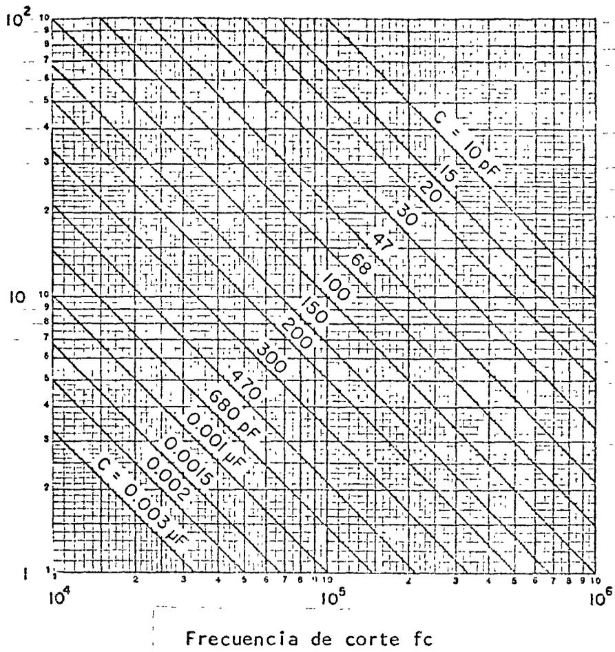
GRAFICA PARA DETERMINA EL PARAMETRO K PARA  $f_c$  COMPRENDIDA ENTRE  $10^4$  y  $10^6$  Hz
