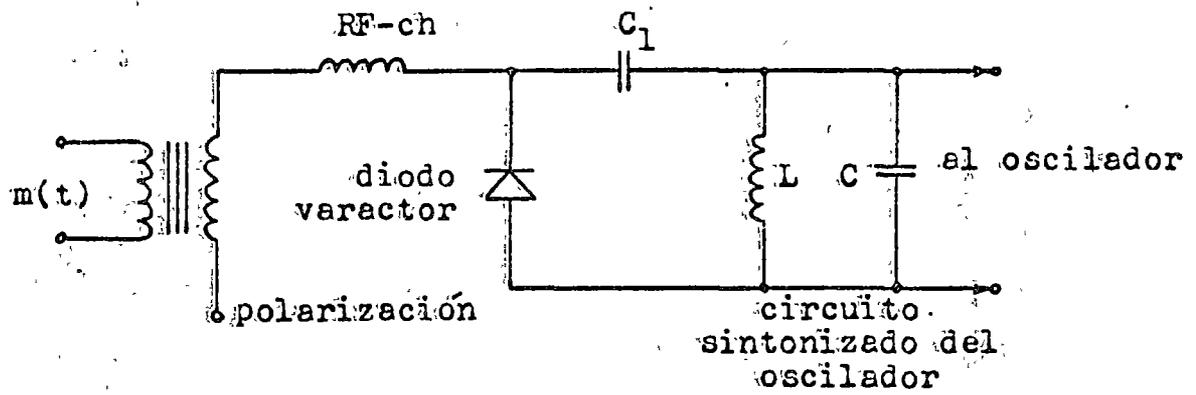
Fig. 2.15 Modulador de FM de diodo varactor.
