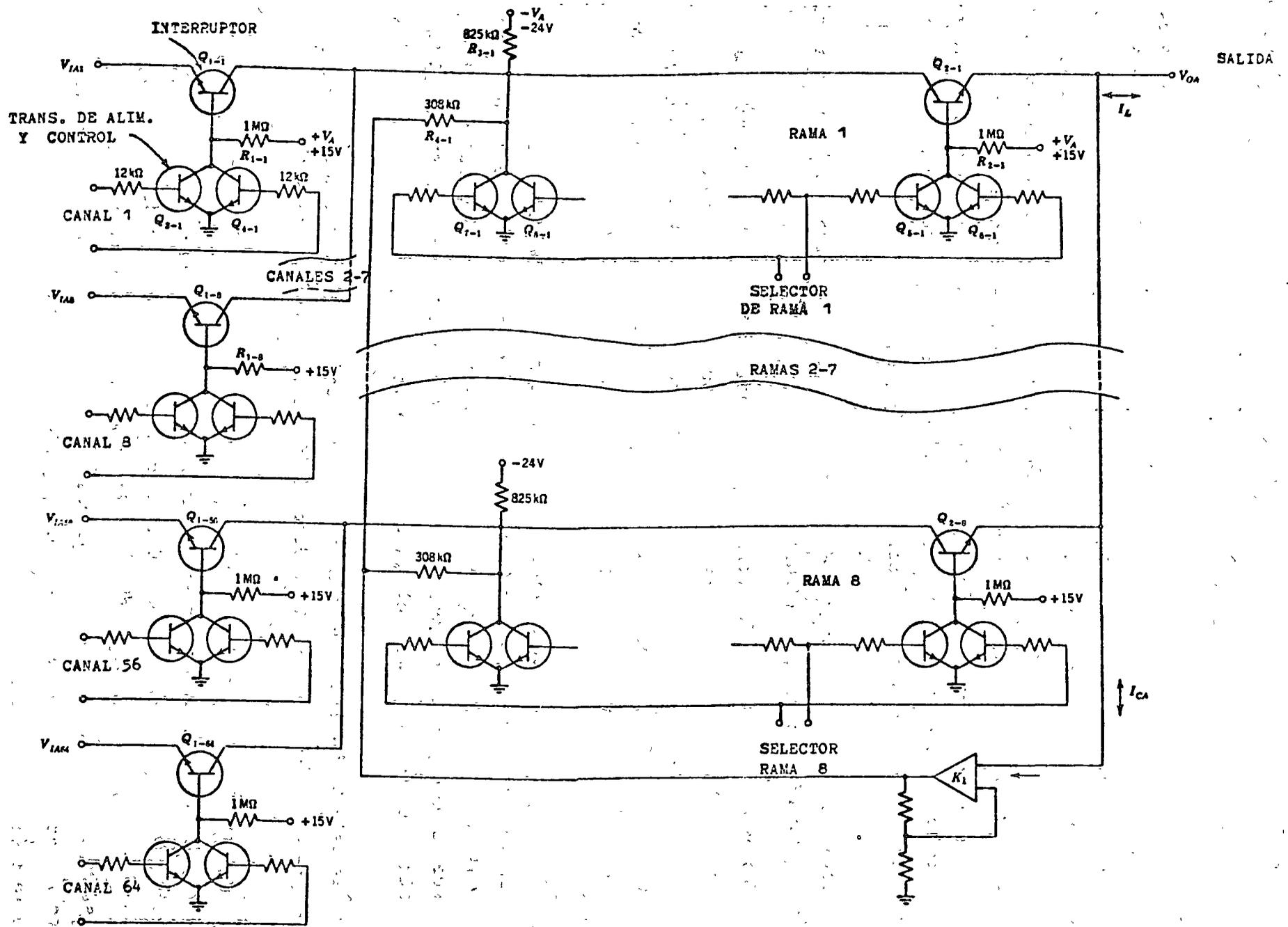
FIG. 3.3.5 CONMUTADOR A BASE DE TRANSISTORES BIPOLARES
