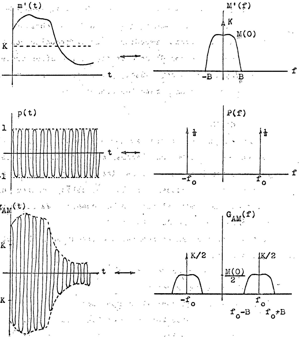
Fig. 2.2 Las señales y sus espectros en la modulación de AM
